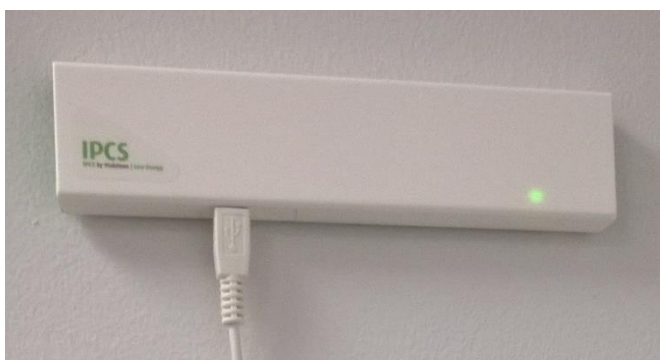
KUVA 17 9Solutions-node antenni (Pulkkinen 2016-02-18.)
