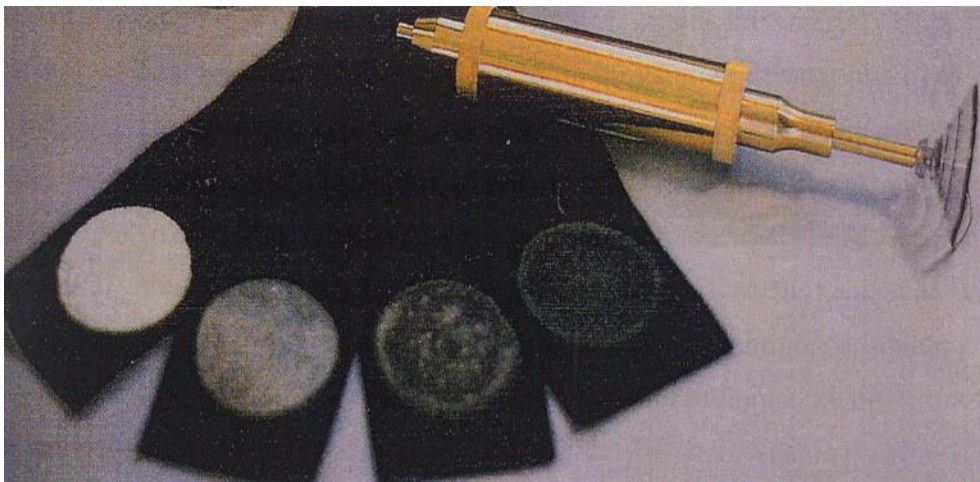
Kuva 17. Musta kangas -menetelmässä käytettävä pölymittalaite ja pölykankaita (20)
