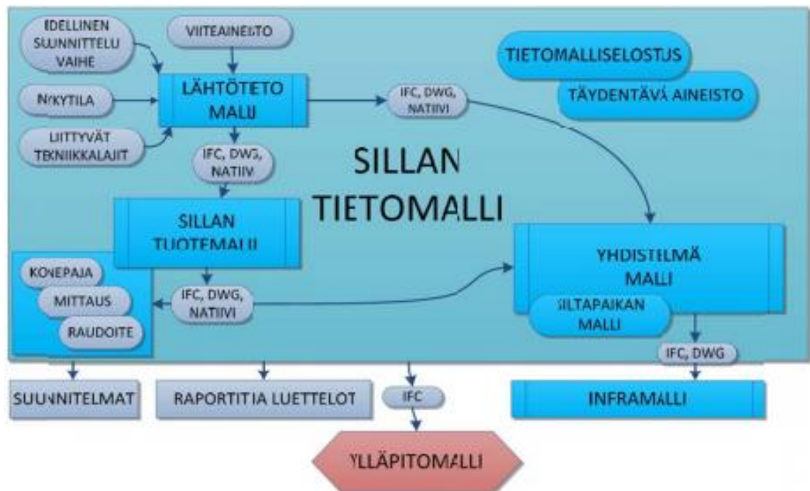
Kuva 1 Sillan tietomallin muodostamisprosessi ja tiedonsiirron formaatit (Järveläinen, Tietomallien yhteensovittaminen siltahankkeessa, 2014)
