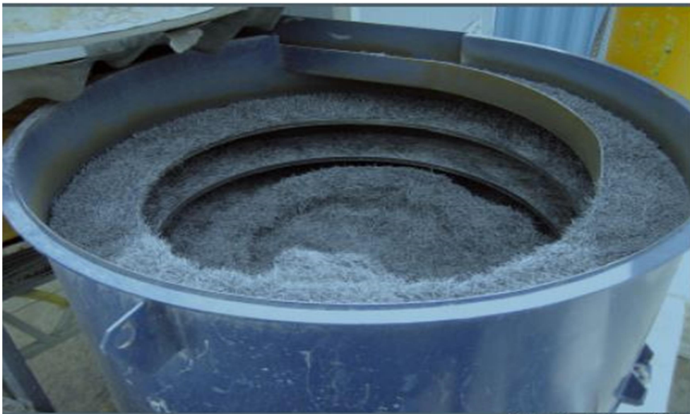
KUVA 10. Kuitujen annostelu betoniasemalla (Lumme 2008)
