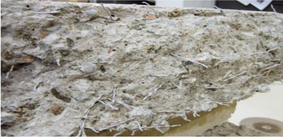
KUVA 4. Teräskuitubetonilaatan leikkaus (Lumme 2008)
