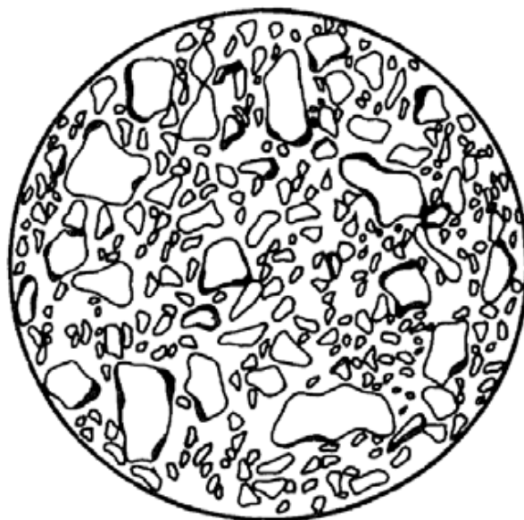
Figur2. De mörkaste partierna visar exempel på mikrosprickor. ( Aronsson & Larsson, 2007)
