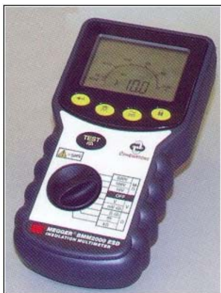
Kuva 26. Eristysvastusmittari Megger BMM 2000 ESD [4]
