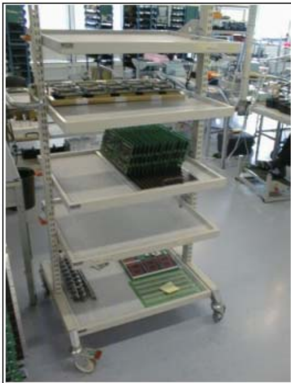
Kuva 31. Itse muutettu ESD-kärry
