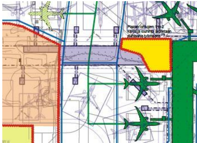
Kuva 18. Plazan perustusvaiheen työmaa-alueen rajaus. [21.]
