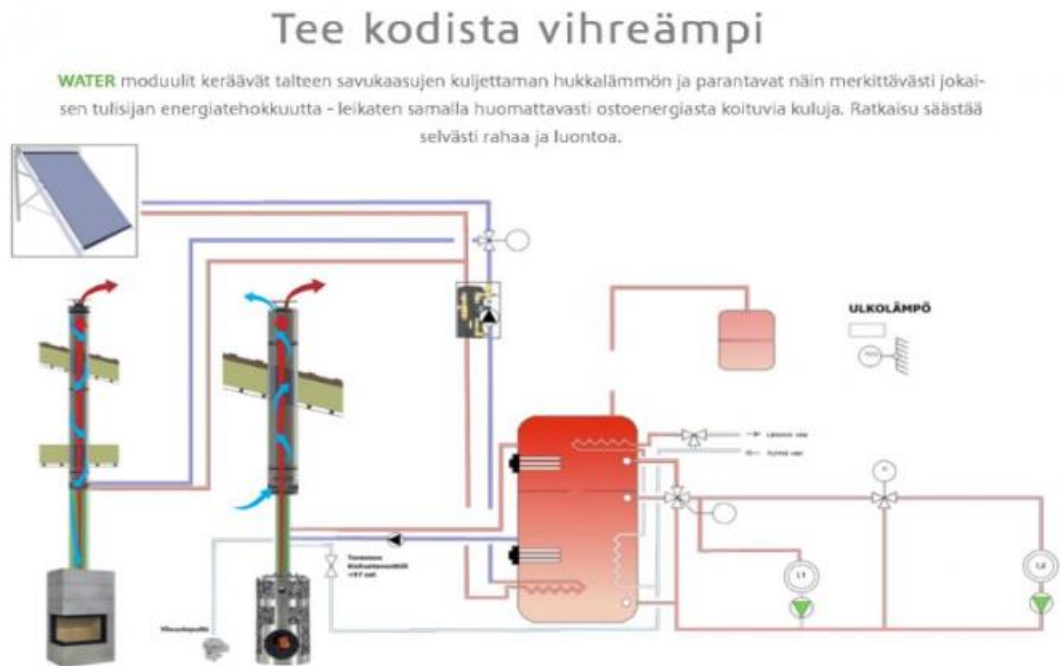
Kuvio 7. Vesikiertoisen aktiivipiipun kytkentä hybridivaraajaan. (Härmä Air 2009.)
