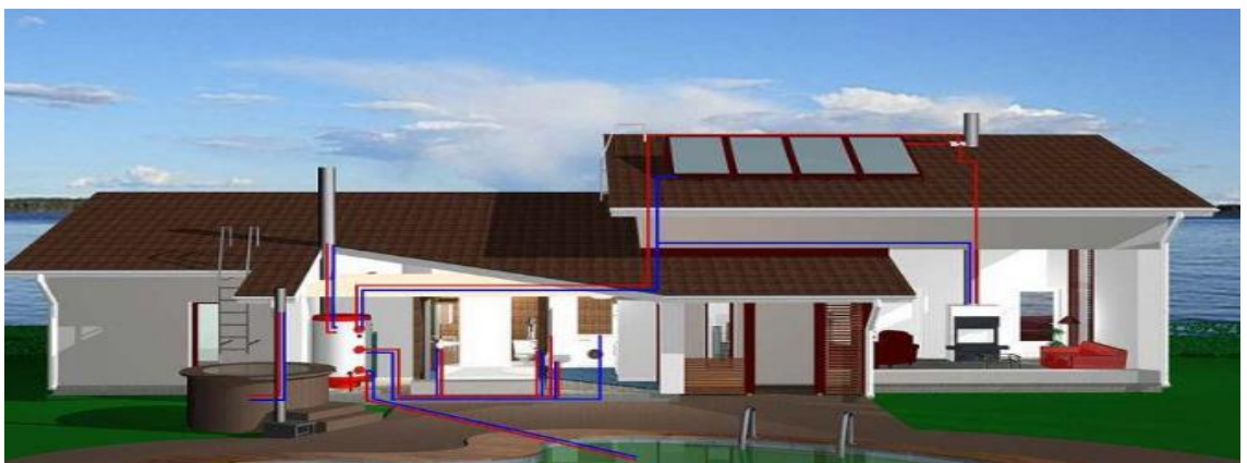
Kuva 5. Havainnekuva vesikiertoisesta aktiivipiipusta paljussa, saunassa ja tulisijassa. (Härmä Air 2009.)
