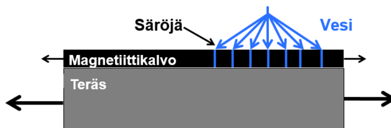
Kuva 9. Veden diffundoituminen metallipinnalle [21].
