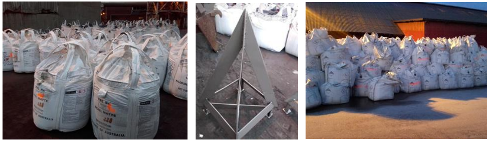
Kuva 11. Lassila & Tikanoja, Rantala Tero. Suurteollisuuspuistoon saapuneita raaka-ainesuursäkkejä, vasemmalla nikkelikiveä sisältäviä suursäkkejä NNH:n kiviaseaman edustalla ja oikealla rikastetta sisältäviä suursäkkejä BOHAn kuparirikastevaraston seinustalla. Keskellä terä, jonka avulla suursäkit tyhjenetään prosesseihin. Viitattu 16.12.2015.
