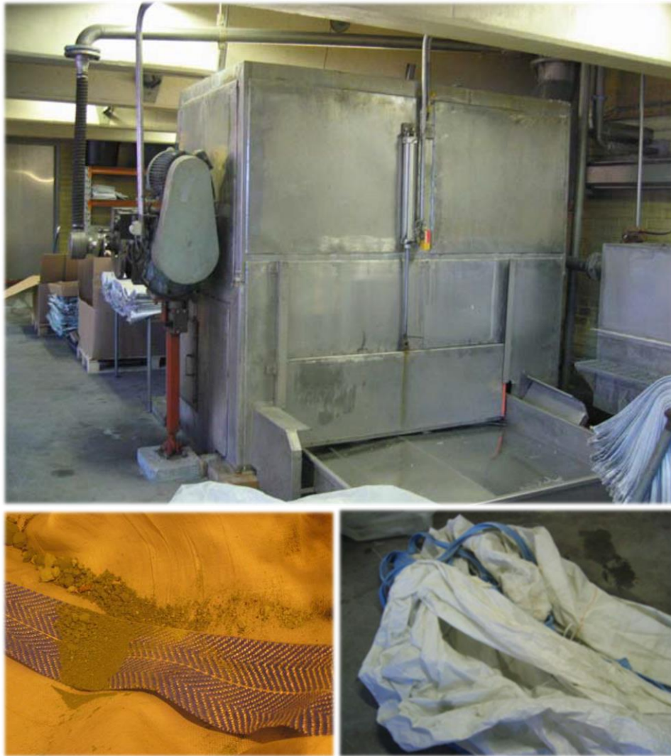
Kuva 14. Lassila & Tikanoja, Lammi Eeva. Suursäkkien koepesussa käytetty pesukone ja suursäkki kuvattuna ennen ja jälkeen koepesun. Viitattu 10.1.2016. Liite 1, Raportti suursäkkien koepesusta 11.5.2004.
