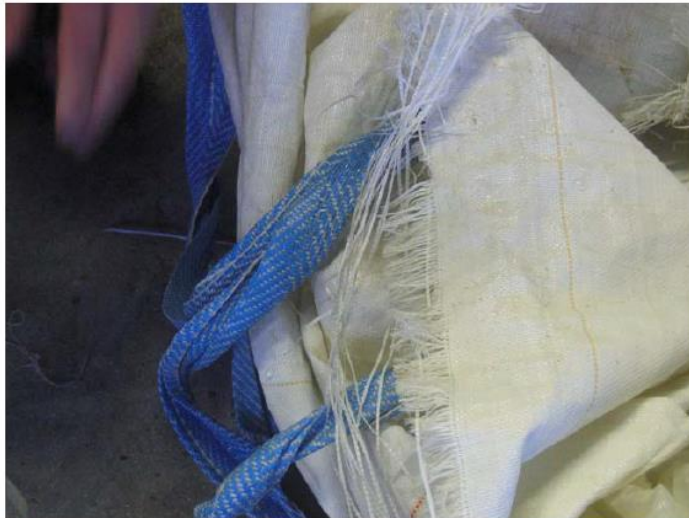
Riisteet hankaloittavat työtä. Ne tukkivat pesukoneen vedenpoistoputken.
