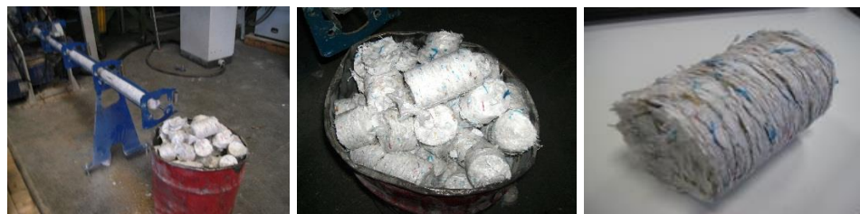
Kuva 25. Haba Group Oy. Muovista valmistettuja brikettejä. Viitattu 29.2.2016. Haba Group Oy:n sisäinen materiaali.
