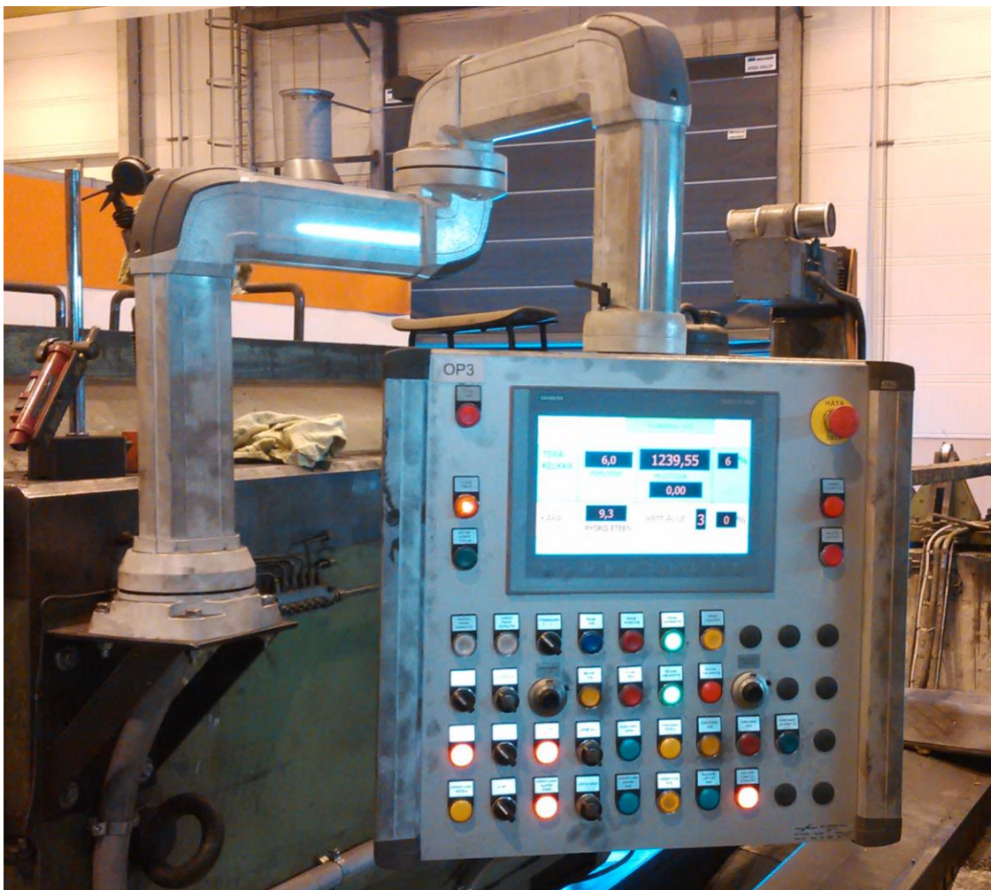
KUVA 6. Uusi työstökoneen kannatinjärjestelmällinen pääohjaukskotelo käytössä
