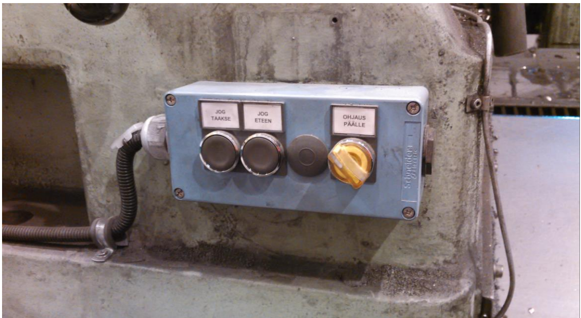
KUVA 7. Uusi työstökoneen lisäohjauksotelon käytössä
