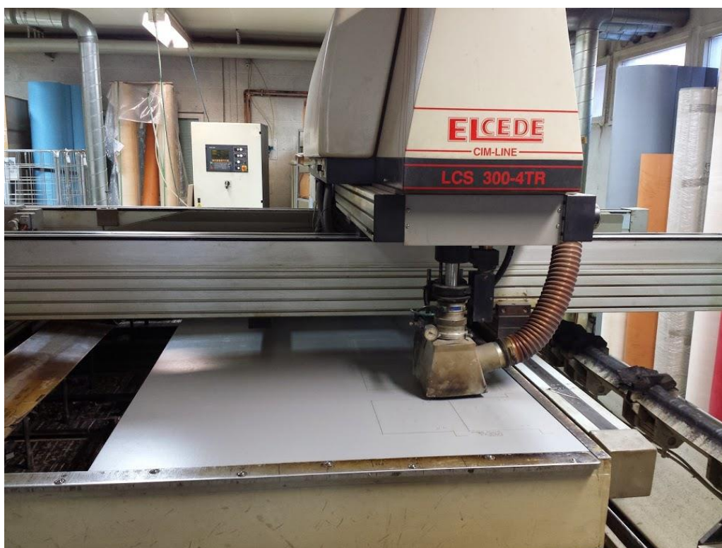
KUVA 13. Stanssaustyökälun teritysurien laserleikkaus
