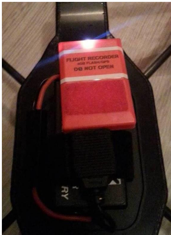
KUVA 9. Flight Recorder asetetaan akun päälle ja kiinnitetään USB-väylään
