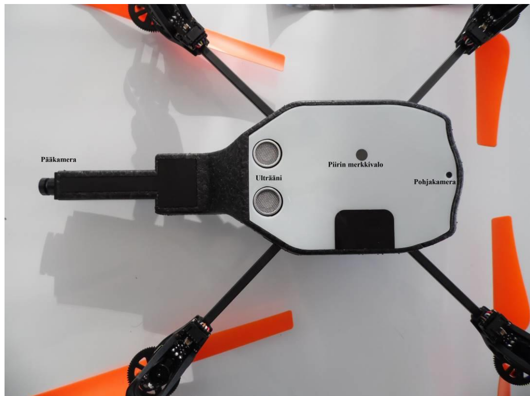
KUVA 2. Vasemmalta oikealle pääkamera, ultraääni, piirin merkkivalo ja pohjakamera
