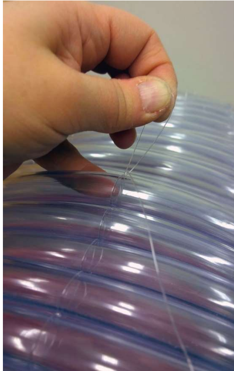
Kuva 3. Letkujen kiinnitystä siimalla
