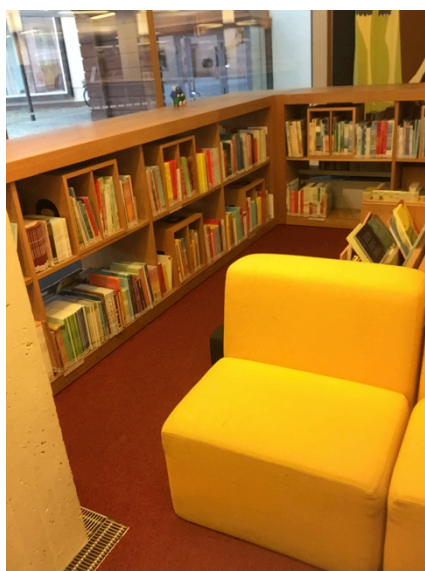
KUVA 4. Istuimen ja pylvään väliin jää todella vähän tilaa (alle 90 cm), eikä sitä pääsisi kulkemaan pyörätuolilla. Ennen kuvaa poimin vielä kirjoja ja tyyntyjä pois lattialta. Kuva on otettu lastenosastolla.
