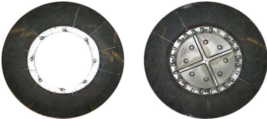
Kuva 4. Kuvassa vasemmalla staattoripuolen jauhinkiekkko ja oikealla roottoripuolen jauhinkiekkko.
