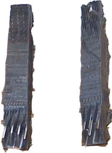
Kuva 12. Leikatut jauhimen terät.
