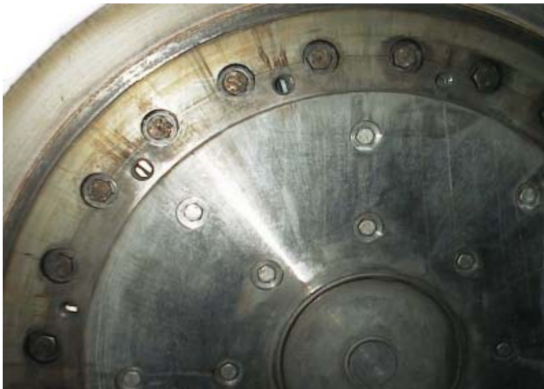
Kuva 10. Jauhimen terien kiinnitys.
