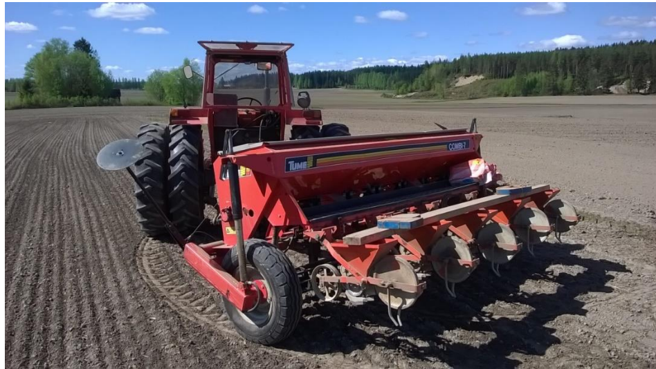
Kuva 2. Kylvö suoritettiin Lounakosken tilalla 26.5.2015. Käytössä on vanha sokerijuurikkaankylvökone. Kolopyörän kolot on porattu isommiksi ja yksiköiden päällä oli painotusta, jotta yksiköt pysyvät tukevasti maassa. Tähän on tarkoitus rakentaa parempi painotusmekanismi.
