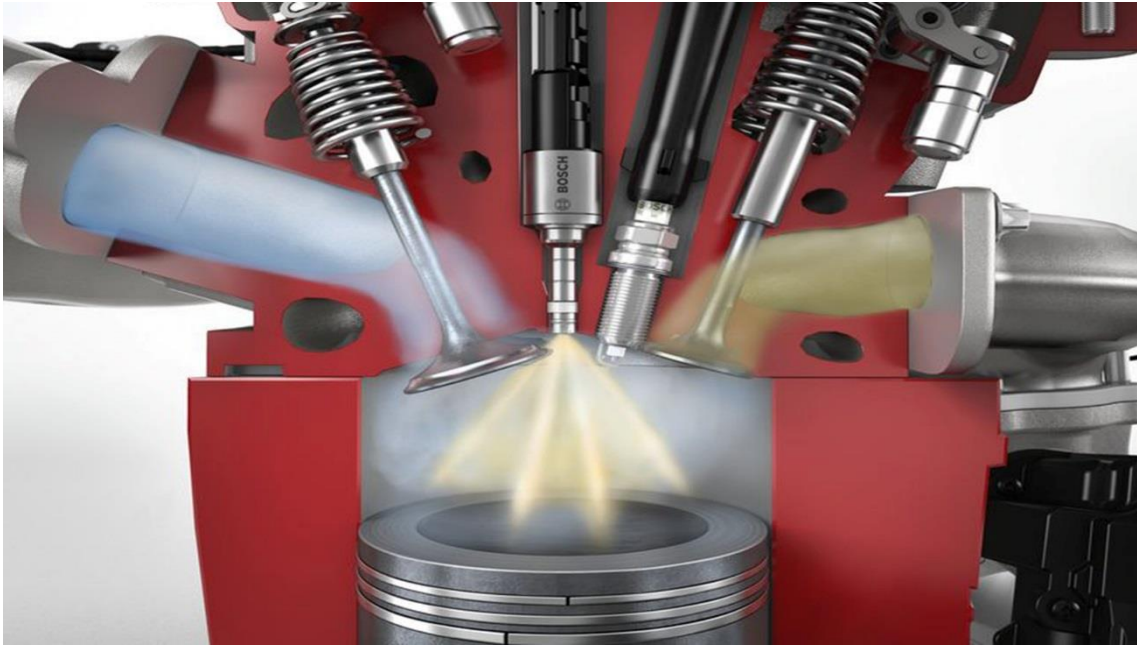
KUVA 2. Suoraruiskutuksen periaate (2, Linkit Powertrain -> Gasoline direct injection)
