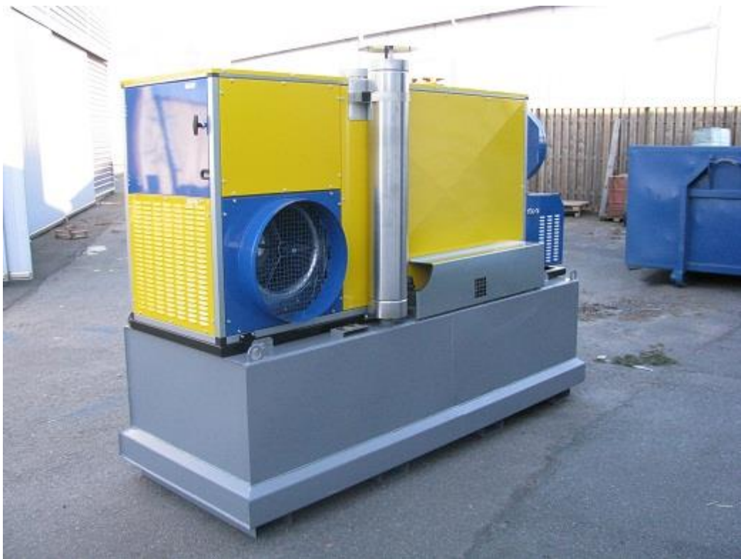
KUVA 26. Kuvassa on polttoöljykäyttöinen Polar Heatmobil lämpökontti. (Ramirent Finland Oy)
