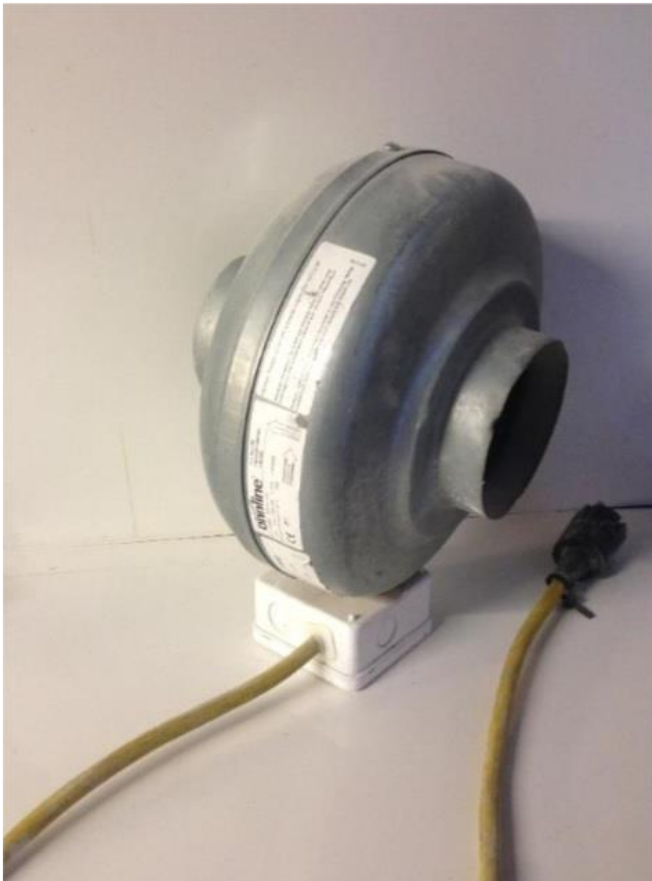
KUVA 21. Kuvassa on Asunto Oy Sipoon Tuhkimon työmaalla käytetty pistotulppaliitännällä varustettu kanavapuhallin.
