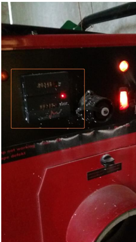
KUVA 13. Tietyissä kuivainmalleissa on olemassa käyttötuntimittari sekä sähkönkulutusmittari, joiden avulla työmaalla on mahdollista kerätä mittausdataa, jonka avulla saadaan muun muassa kartoitettua kuivaamisen kustannuksia. Kuvassa yhdistelmäkone Corroventa CTR LKV 1000XT:n mittaristo.
