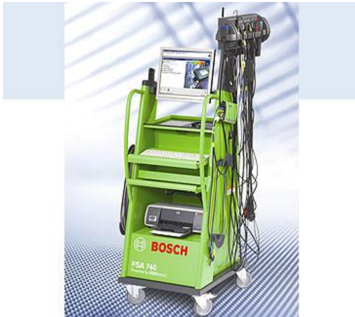
Kuva 1: Bosch FSA740 diagnoositestauslaite
