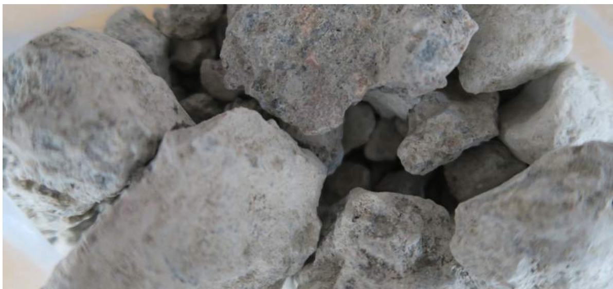
KUVA 5: Betonimursketta josta voi valmistaa kierrätysbetonia. (Sirkkiä 2015.)
