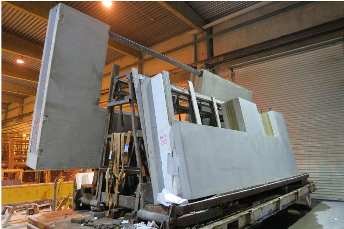
KUVA 4: Valmiita betonielementtejä Betonimestarit Oy:n tehtaalla. (Sirkkiä 2015)
