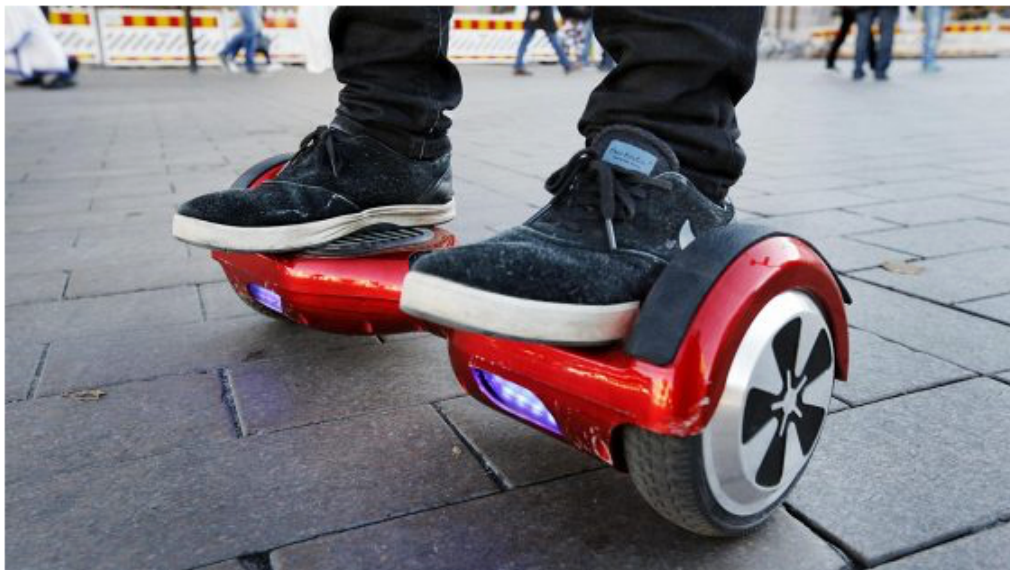
Kuva 5. Sähköisellä tasapainolaudalla seistään kahden renkaan välissä olevilla astinlaudoilla [25].
