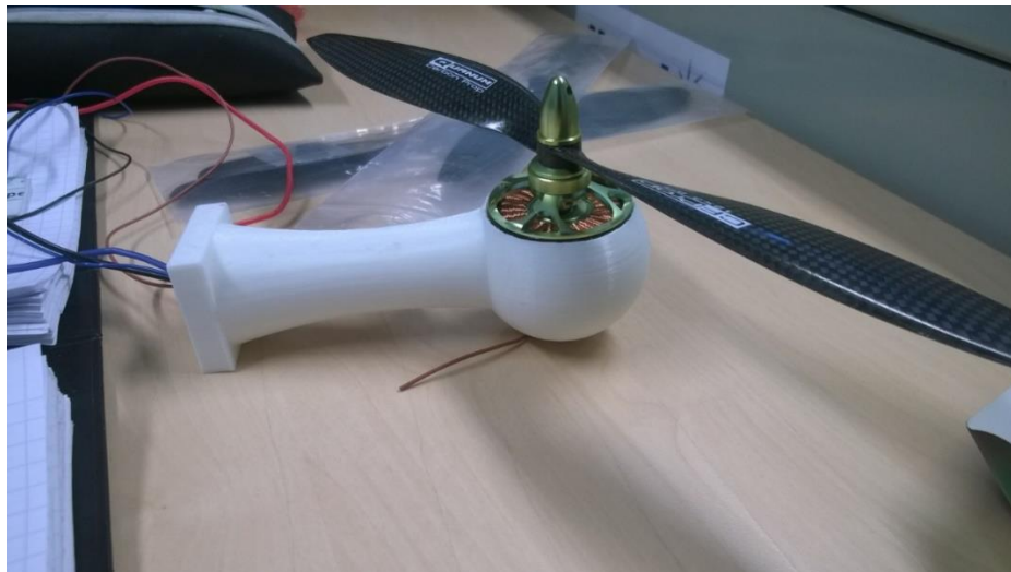
Kuva 1. 3D-tulostettu nelikopterin propellin pidike
