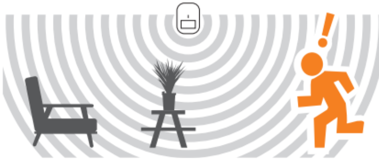
KUVA 4 Ns. infrapunaverkkoon saapuva ihminen aiheuttaa PIR-tunnistimen havahtumisen (8).
