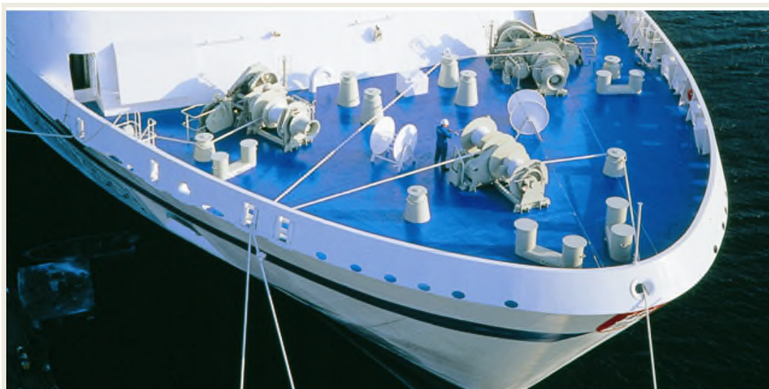
Kuva 1. Esimerkki keulan mooring-laitteiden sijoittelusta (Rolls-Royce)
