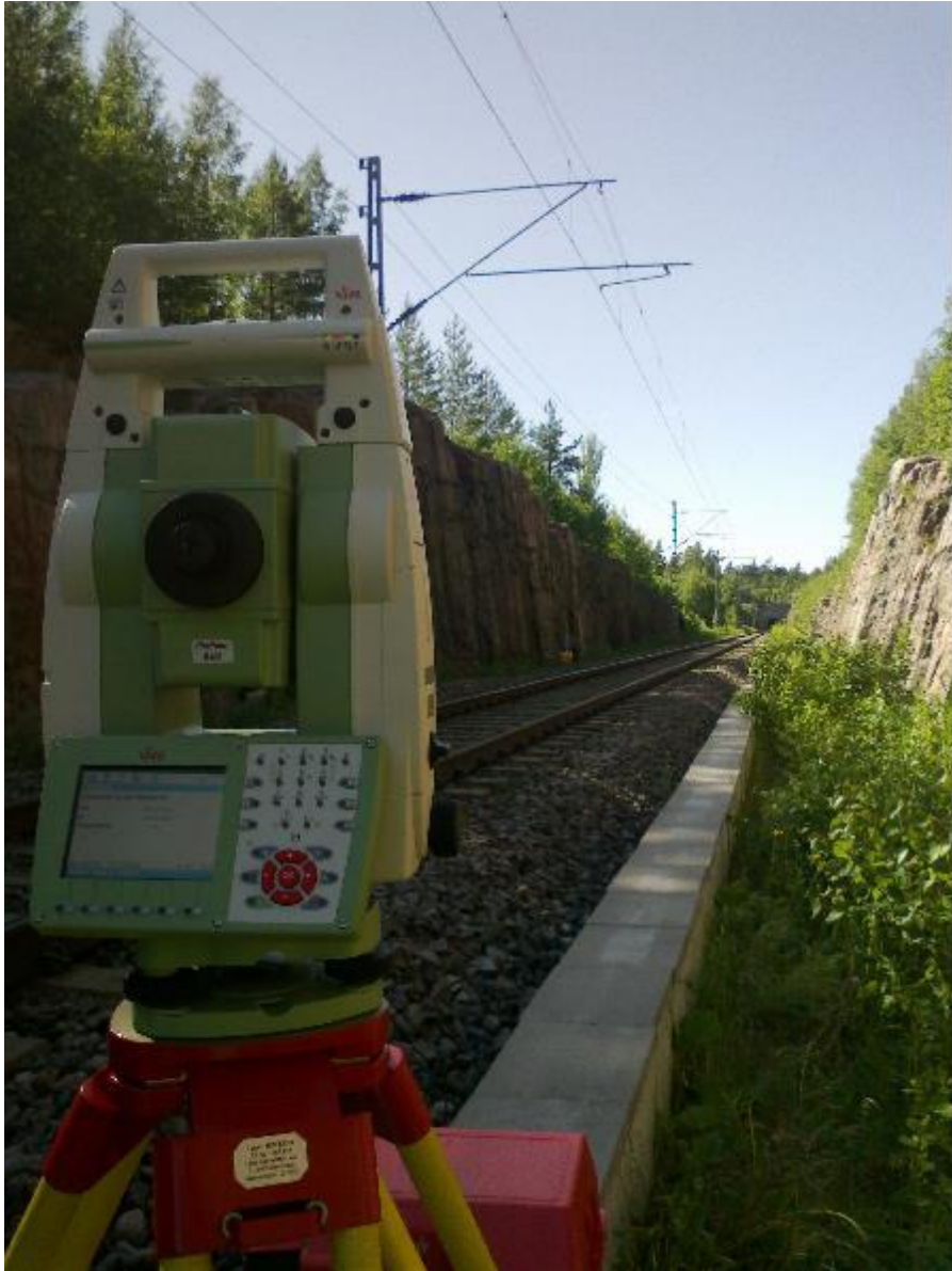
Kuva 1. VR Trackin käyttämä mittalaite, Leica TS15. (Kuva: Jani Hietanen)
