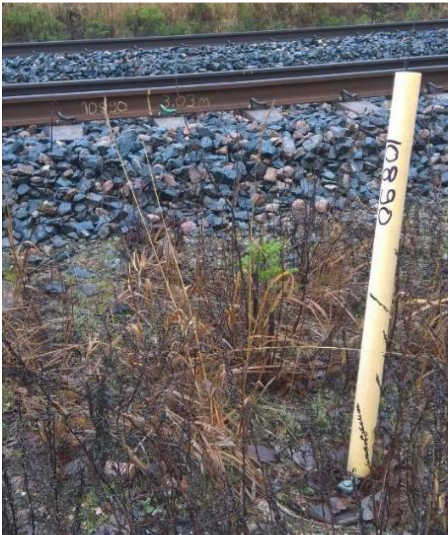
Kuva 8. Pisteiden merkintä kiskoon ja näkyvöityspaaluun. (Kuva: Tinja Sarjanen)
