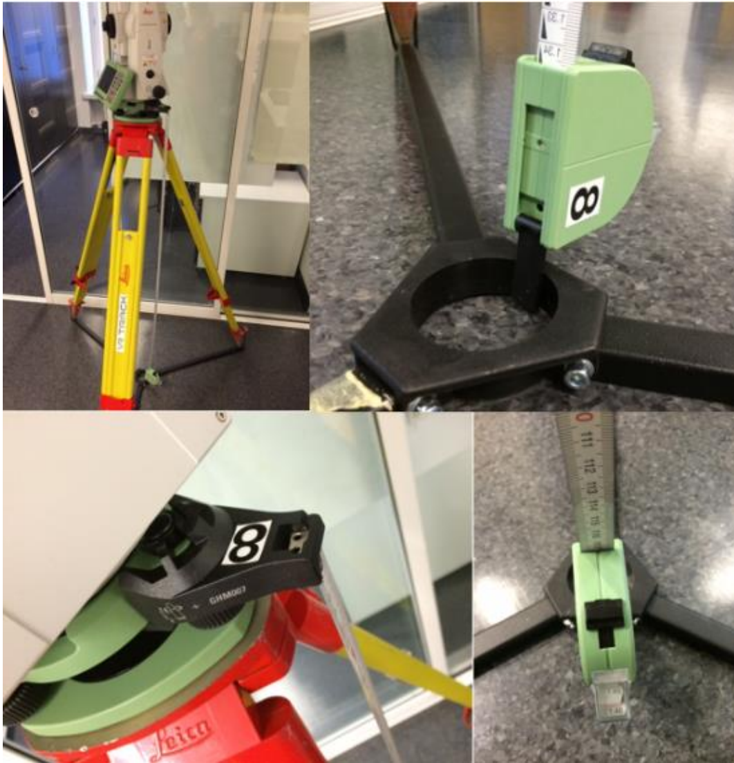
Kuva 2. Leican mittanauhan käyttö. (Kuva: Tinja Sarjanen)
