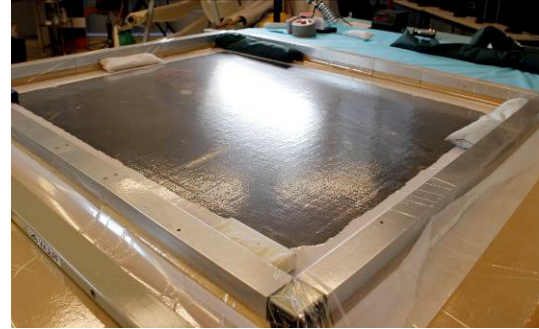
Kuva 58. Maalaus alipaineessa Melinex®-kalvon alla
