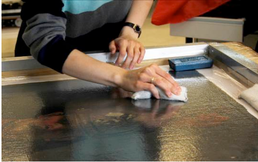
Kuva 57. Maalaus alipaineessa; rypyt hierottiin hiekkapussilla Melinex®-kalvon läpi
