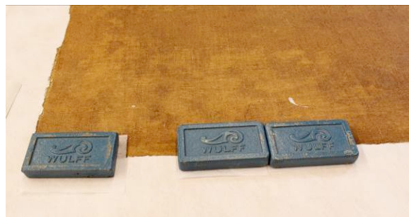
Kuva 49. Suoristetut kankaan pienet deformaatiot jätettiin painojen alle yön yli
