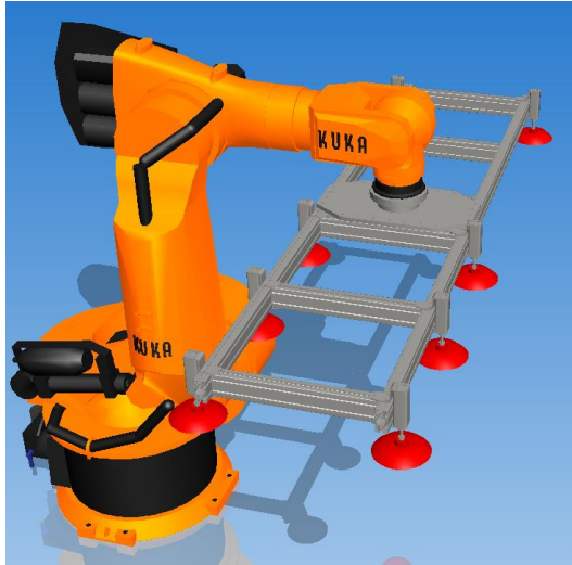
KUVIO 11. Kuka KR500 -robotti ja tarttuja
