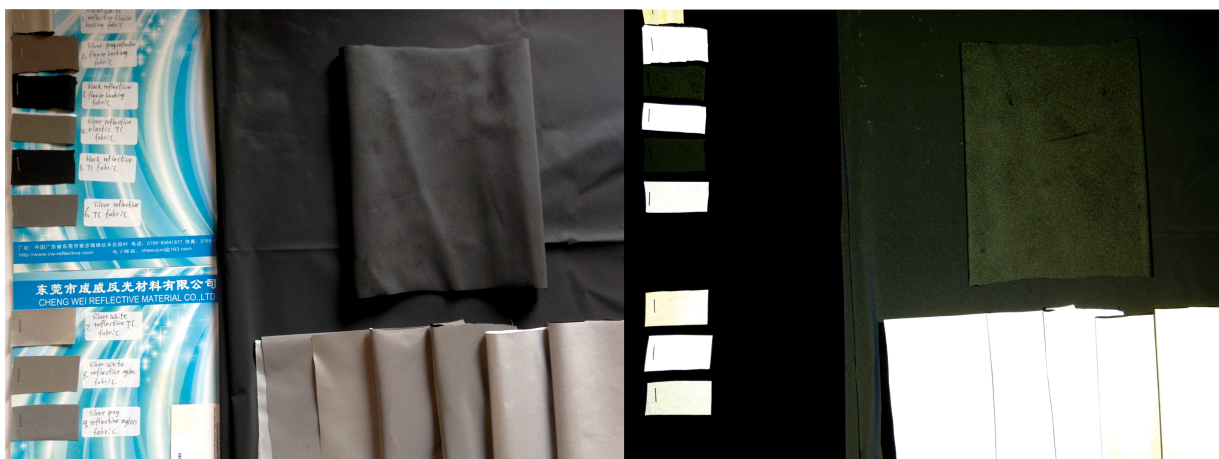
Kuvio 17. Näytteitä kiinalaisista heijastavista kankaista. Vasemmalla päivänvalossa, oikealla salamalla otettu kuva, josta ilmenee materiaalien heijastavuus.
