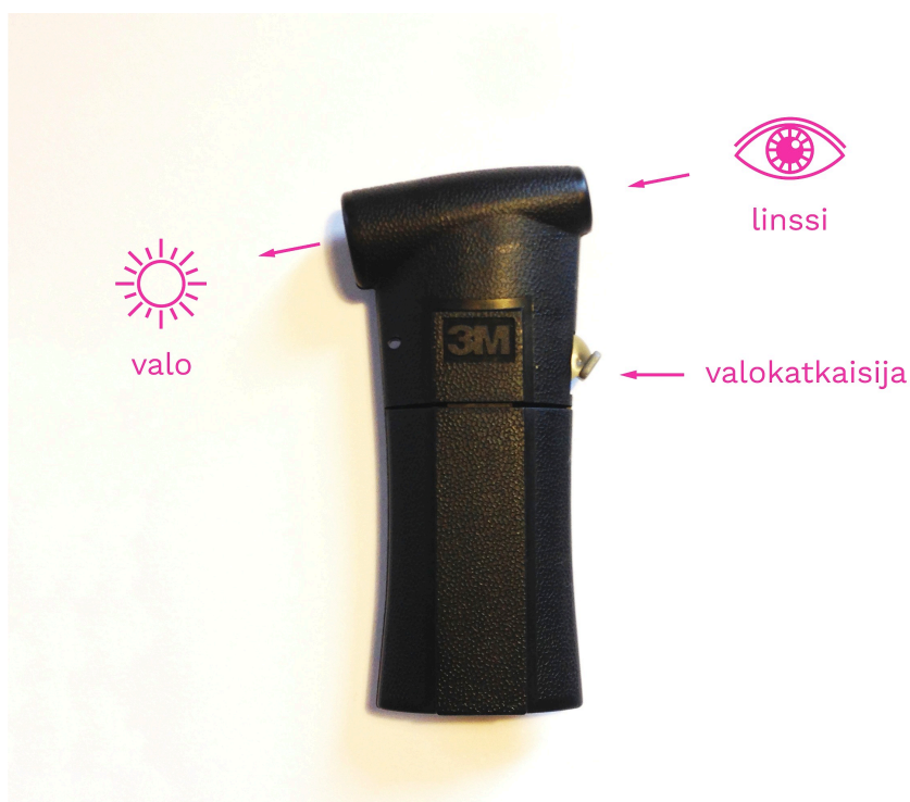
Kuvio 16. 3M:n heijastimien tutkimiseen tarkoitettu apulaite
