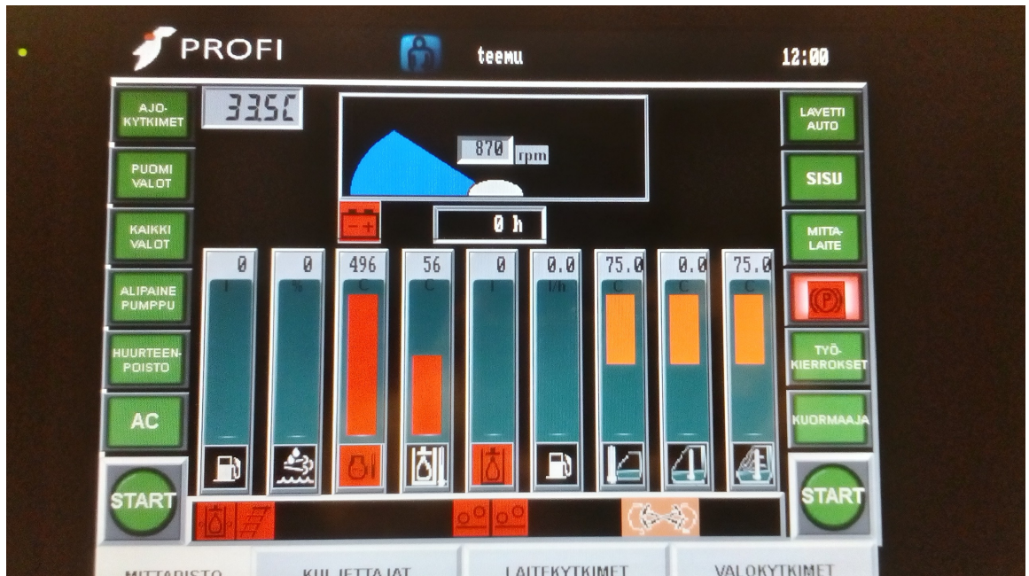
Kuva 31. Käyttöliittymän kierrosmittari, johon on simuloitu kierroksia CAN-väylää pitkin.
