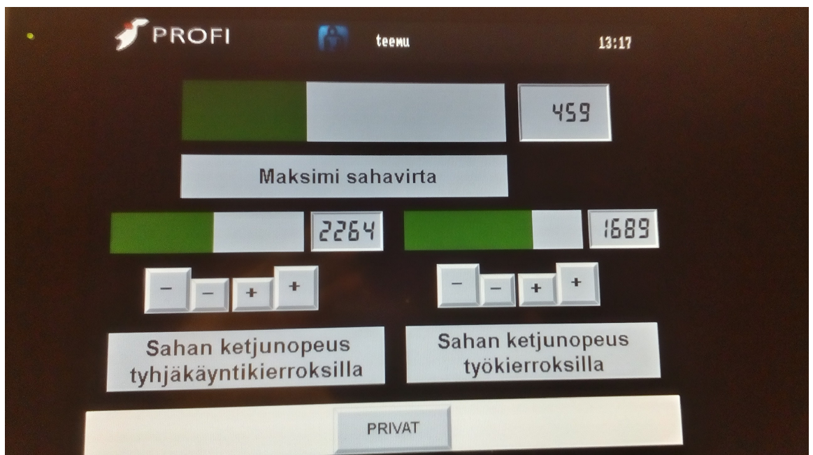
Kuva 33. Maksimi sahavirta, kun simuloitu kierrosluku on 1800 kierrosta minuutissa.
