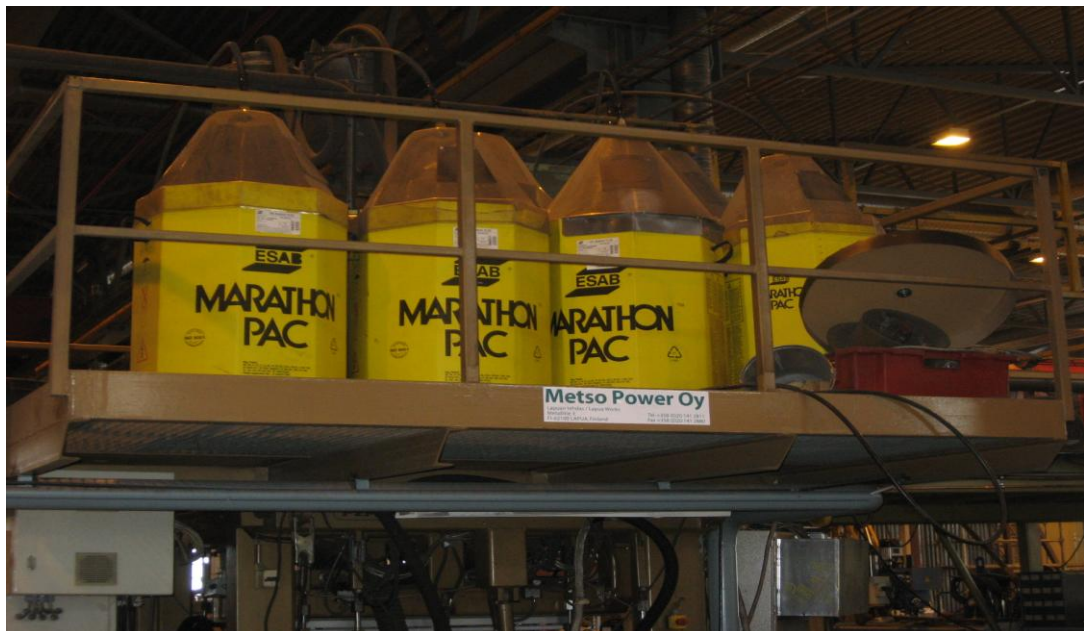
Kuvio 25. Lisäainelangat 4 kpl Marathon pac -rullakoneelle sijoitettuna ylätasanteelle.
