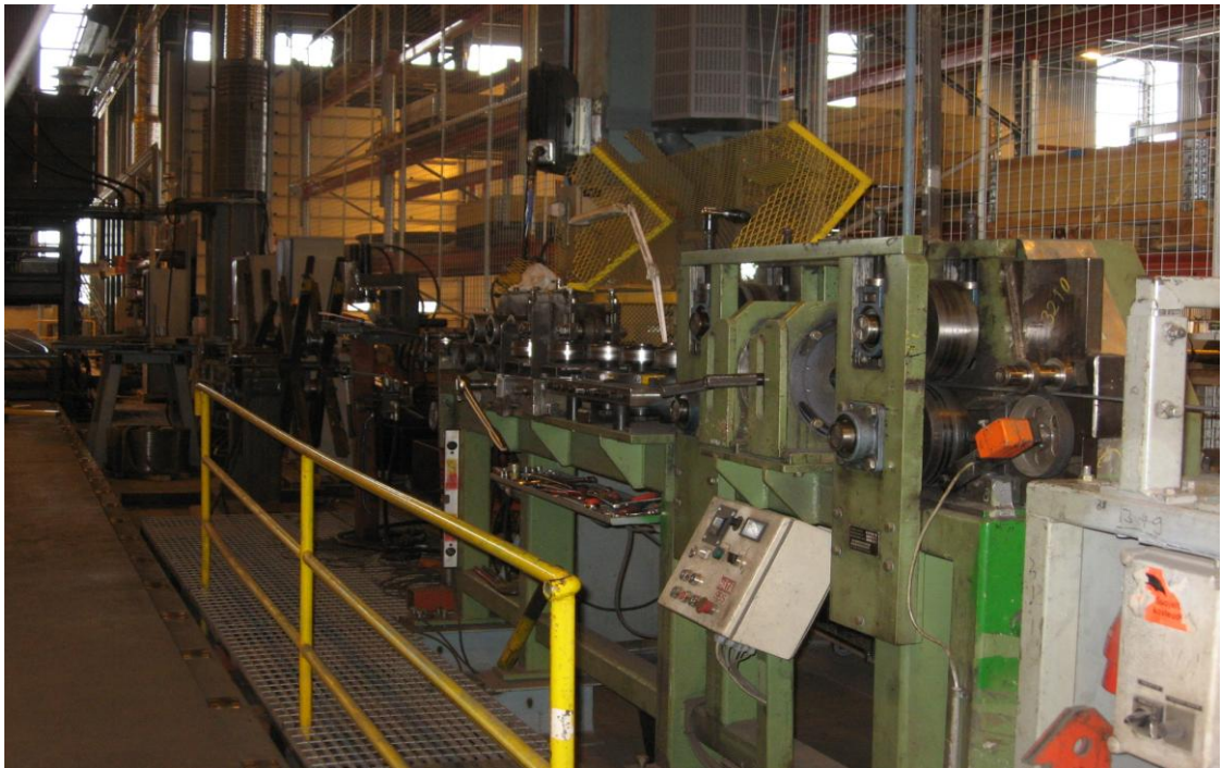
Kuvio 20. Kalibrointikoneen suojaverkot ja häätä-seis-painike ohjauspaneelissa.
