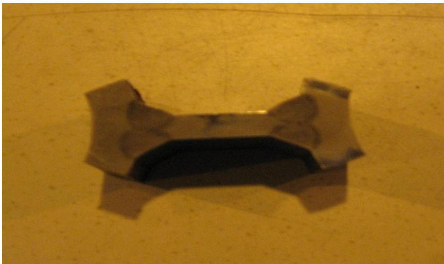
Kuvio 7. Paneelin putkista ja evästä tehty hie. Kuvasta huomaa hitsin sulamisen putkessa ja evässä.
