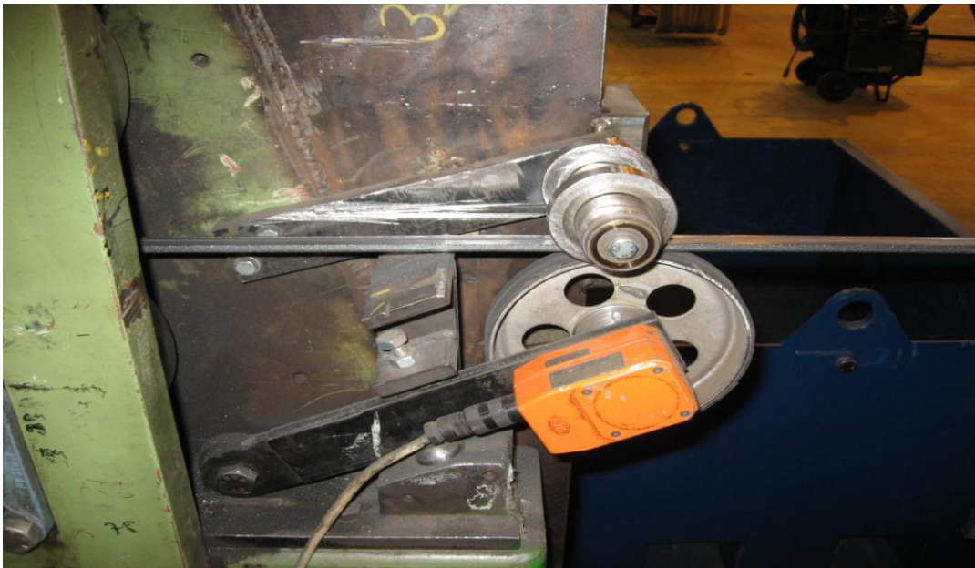
Kuvio 11. Evän pituuden mittauslaite
