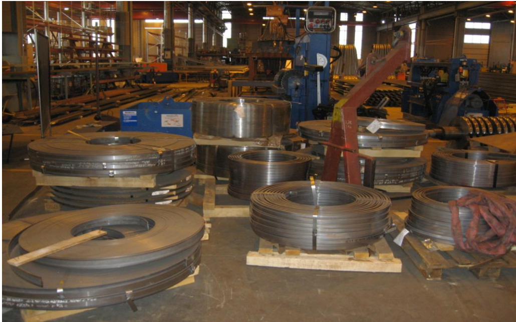
Kuvio 36. Erilaisia lattakeloja sekä niiden nostamiseen tarkoitettu nostohaarukka.
