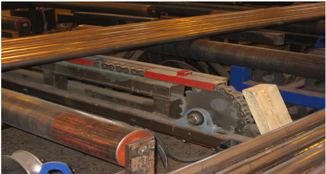
Kuvio 6. Paneeliseinä rullakoneelta tullessaan. Kuvassa myös näkyy paneelin si- vuunsiirtojärjestelmä.
