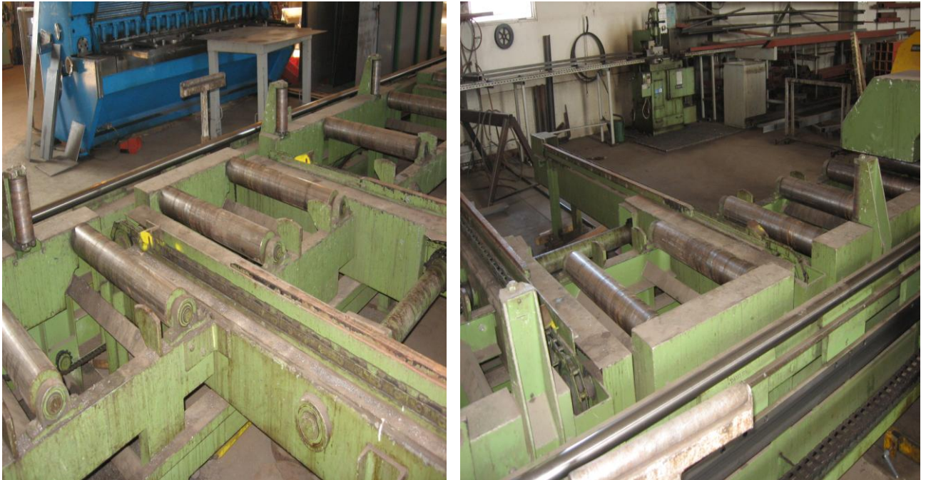
Kuvio 48. Vannesahalla käytössä oleva rullarata. Kuvio 49. Mekaaniset työntimet siirtävät leikatun osan sivuun. Työntimet tulevat rullien välistä.
