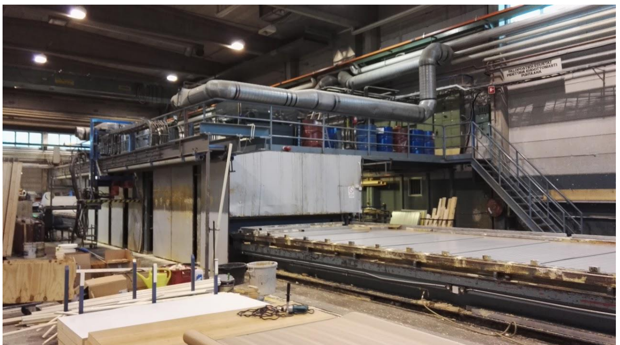
Kuva 5. Työmaatilojen elementtien PU-vaahdotuskone (Ruuskanen 2016.)
