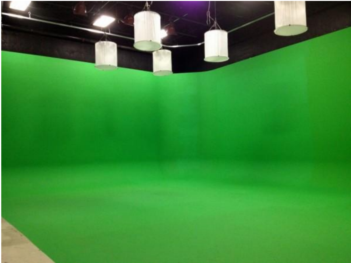
Kuva 5. Cycloramassa lattia ja seinät yhdistyvät saumattomasti [20].
