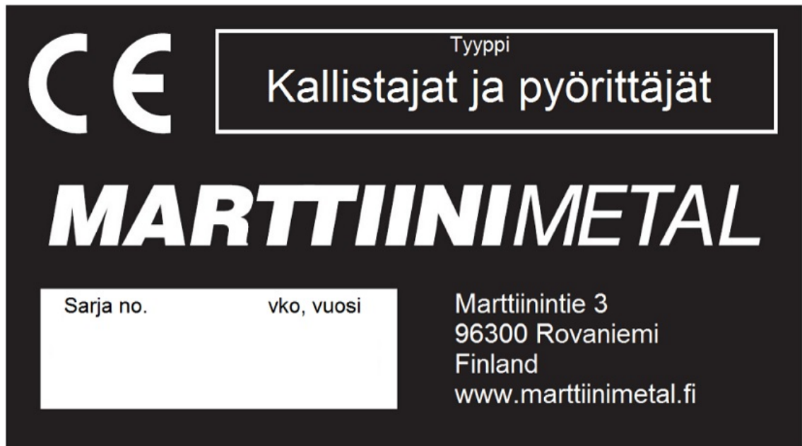
KUVA 5. Esimerkki Marttiini Metal Oy:n käyttämästä konekilvestä.
