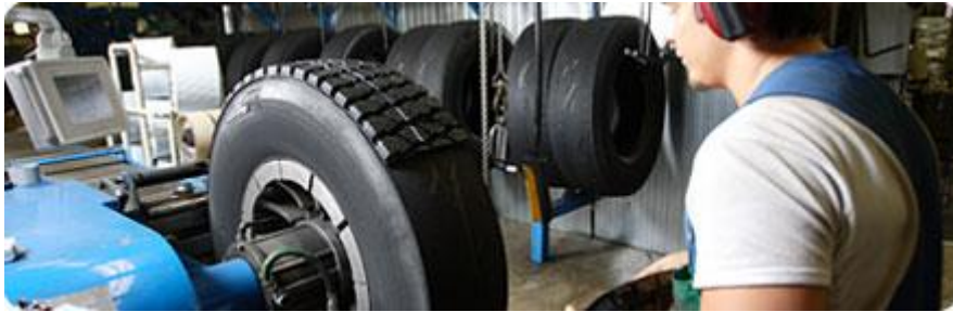
Kuva 4. Renkaan kulutuspinnan kiinnittäminen vulkanoituun runkoon [26].
