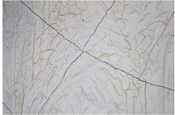
Kuva 18. Suurennos 4,725x Mikroskooppikuvassa nähtävissä sekä pieniä kuivumisesta johtuvia että ikääntymisestä johtuvia pitkälinjaisempia krakelyyrejä.
