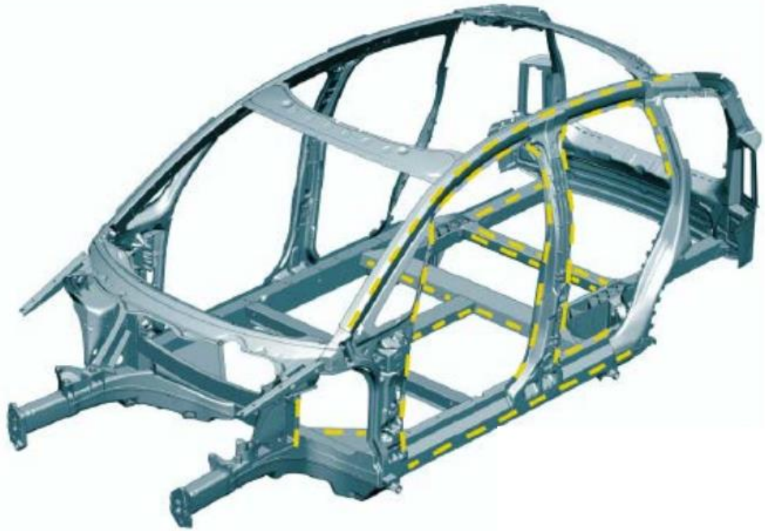
Kuva 12. Audi A2:n lasersaumat ovat merkitty keltaisella katkoviivalla (12).
