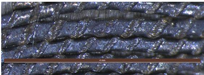
Kuva 15. Stereomikroskooppikuva brokadikankaan metallilankapujotuskuviokuvion alareunasta. Mittaskaala on 4 mm ja suurennos 40-kertainen.
