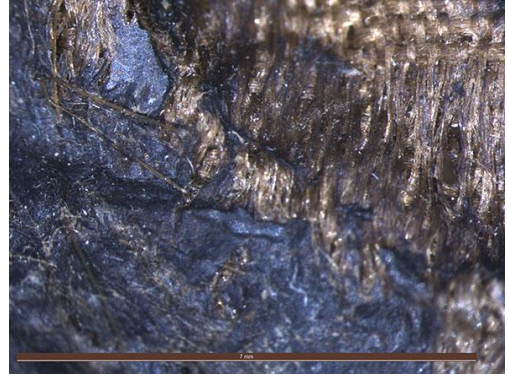
Kuva 27. Stereomikroskooppikuva tyynyn alareunassa olevasta mustasta karstamaisesta liasta.
