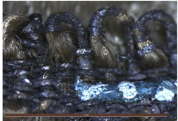
Kuva 24. Stereomikroskooppikuva metallilankapunoksen vaurioituneesta pinnasta. Suurennos on 10-kertainen.
