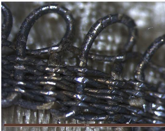
Kuva 14. Stereomikroskooppikuva puvun keskellä edessä ja tyynyn reunoilla olevasta metallilankapunosesta. Alareunan mittaskaala on 7 mm ja suurennos on 10-kertainen.
