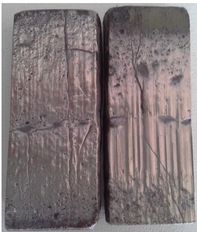
KUVA 63 Kulutetut Ultraplate 4000 -panssarilevyn koekappaleet (Viitala, 2016)
