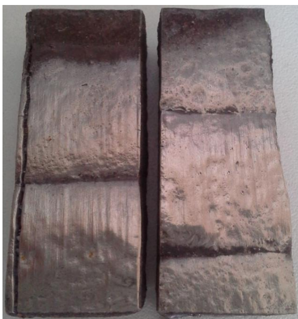
KUVA 58 Kulutetut Coroplate 143 -panssarilevyn koekappaleet (Viitala, 2016)
