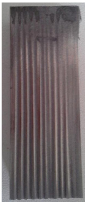
KUVA 67 Kulutettu S235-koekappale (Viitala, 2016)
