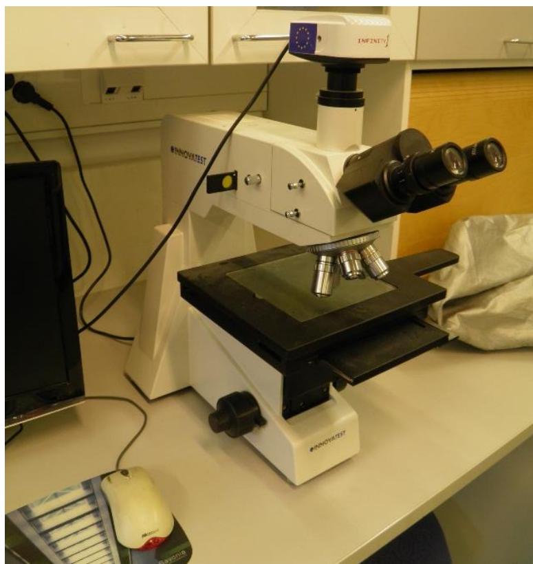
KUVA 49 Tietokoneeseen liitetty kameralla varustettu mikroskooppi (Viitala, 2016)
