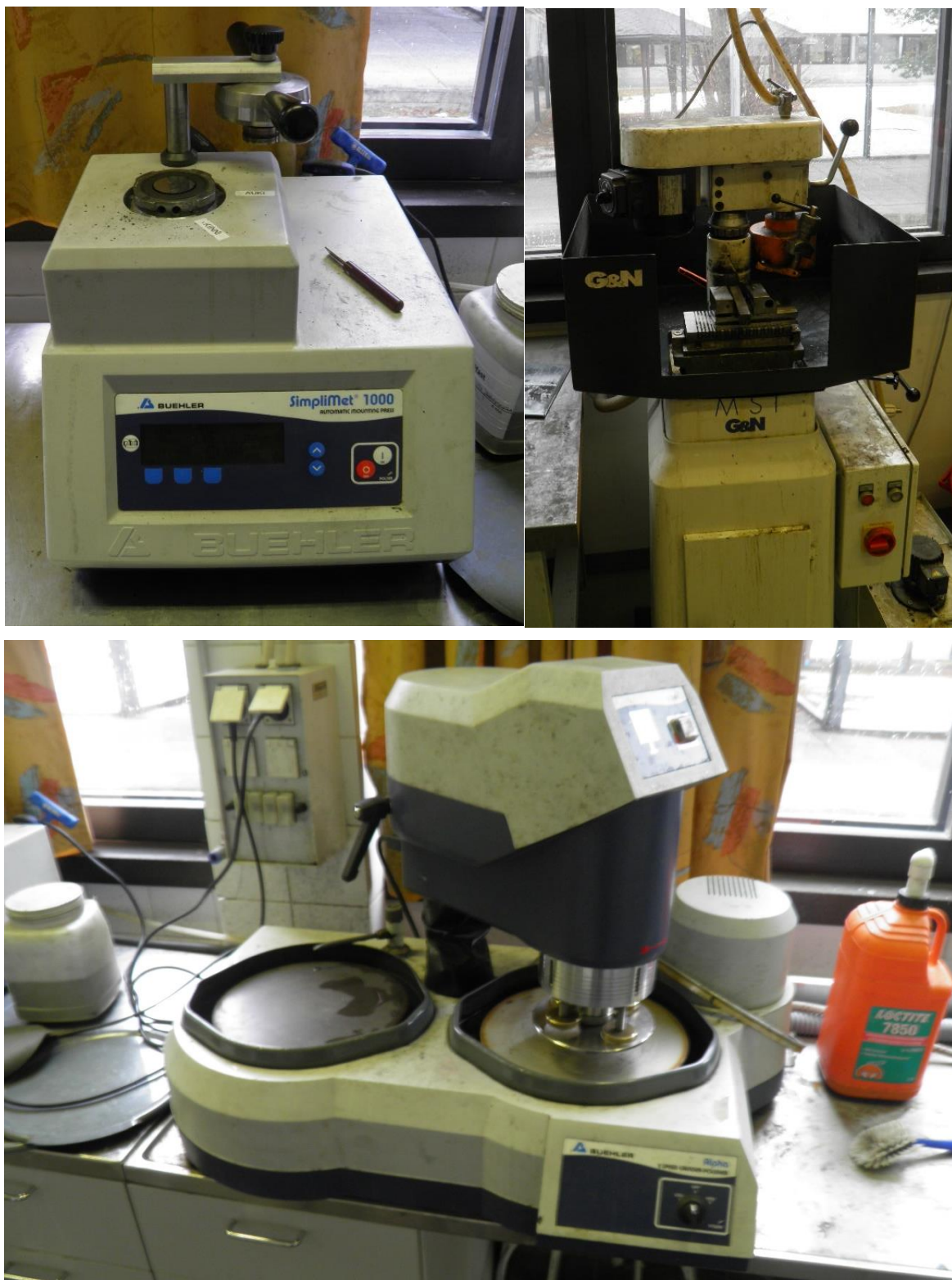
KUVA 23 Hieiden valmistukseen käytetty laitteisto: muovimuotin valamiseen käytetty laite (vas. yllä), jäähdyttävä tasohiomakone (oik. yllä) ja hieiden hiomalaite (alla) (Viitala, 2016)
