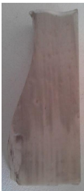
KUVA 65 Kulutettu SKM Ceramic 1 -keraamin koekappale (Viitala, 2016)
