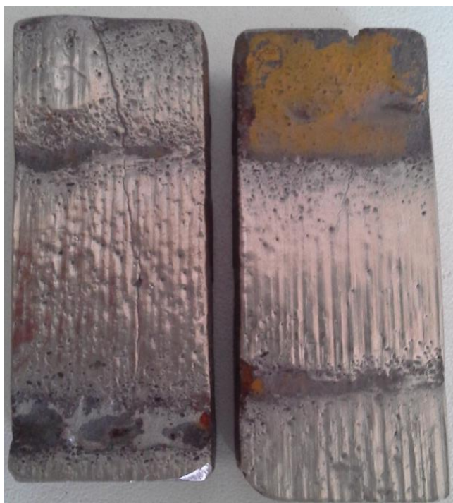
KUVA 60 Kulutetut Ultraplate 2000 -panssarilevyn koekappaleet (Viitala, 2016)
