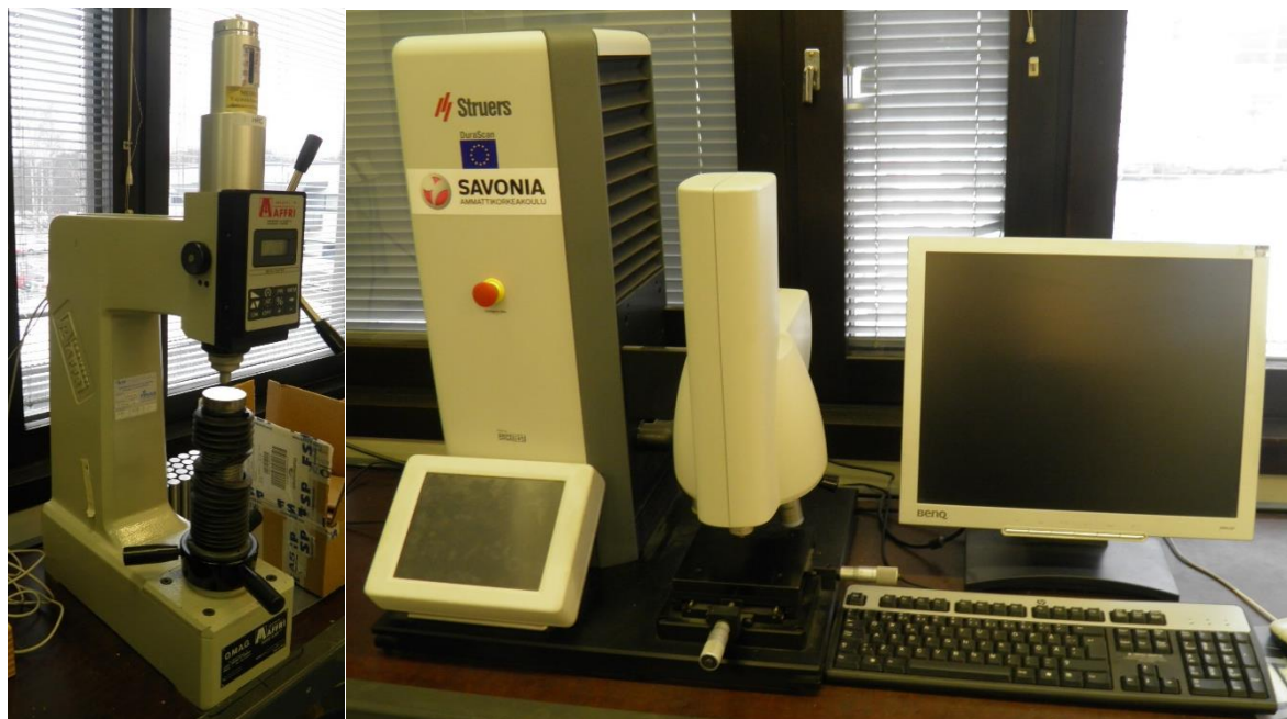
KUVA 22 Vasemmalla Rockwell-kovuusmittauslaite Brevetti Afri Metal Tester O.M.A.G. 296 RS Digital ja oikealla Vickers-mittauslaite DuraScan-20 Hardness Tester (Viitala, 2016)
