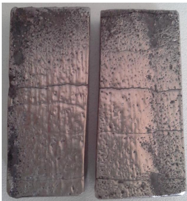
KUVA 62 Kulutetut Ultraplate 3000 (8/5) -panssarilevyn koekappaleet (Viitala, 2016)
