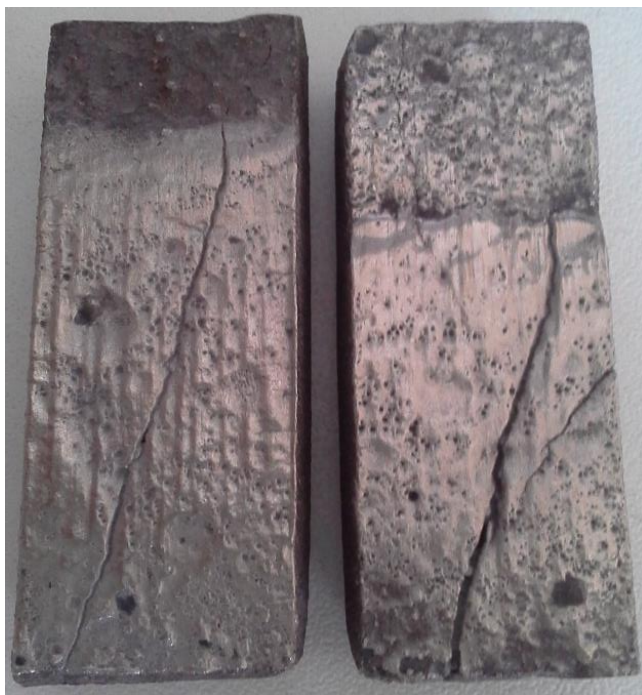
KUVA 59 Kulutetut Impoweld-W 100 -panssarilevyn koekappaleet (Viitala, 2016)
