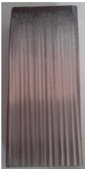
KUVA 66 Kulutettu Hardox 400 -koekappale (Viitala, 2016)
