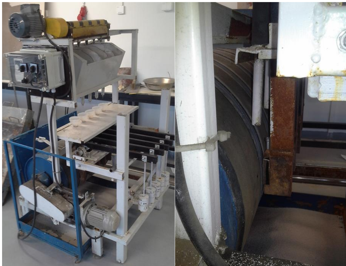
KUVA 57 Kumipyöräabraasiokokeessa käytetty laite (Viitala, 2016)
