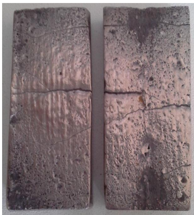
KUVA 61 Kulutetut Ultraplate 3000 (6/4) -panssarilevyn koekappaleet (Viitala, 2016)
