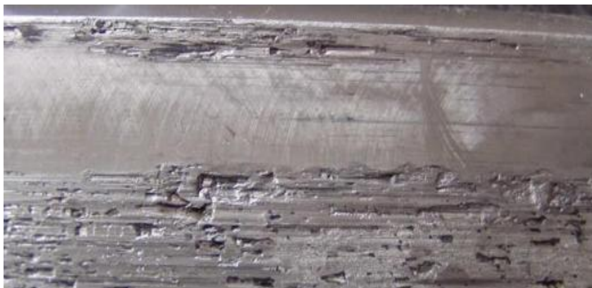
KUVA 4 Abraasiassa on nähtävissä erilaisia uurteita, uria ja naarmuja (Adudra, 2016)
