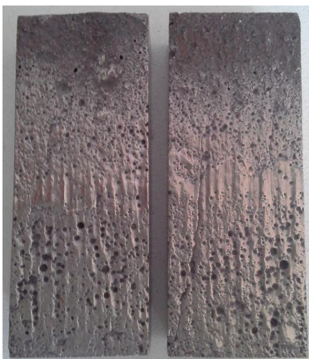
KUVA 64 Kulutetut Vautid 100 -panssarilevyn koekappaleet (Viitala, 2016)
