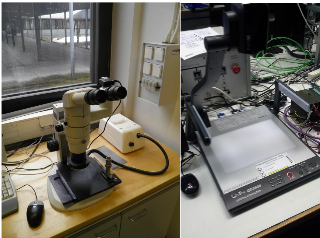
KUVA 24 Makrohietutkimuksissa käytetty stereomikroskooppi (vas.) ja dokumenttikamera (oik.) (Viitala, 2016)
