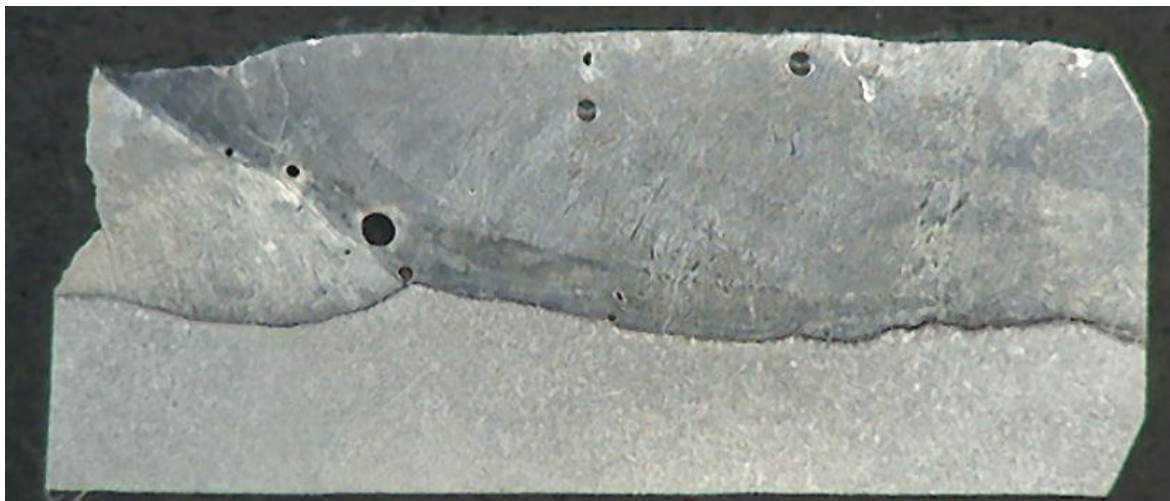
KUVA 30 Ultraplate 4000 -panssarilevyn hie (Viitala, 2016)
