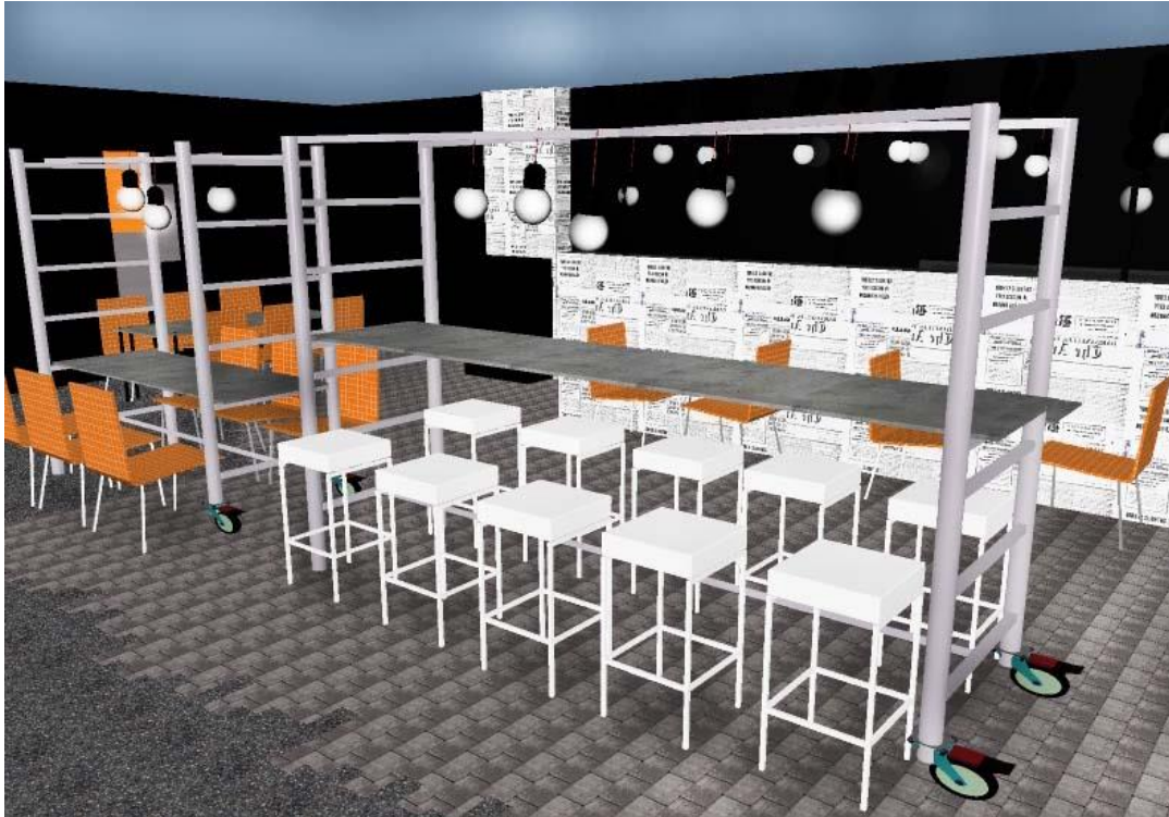
Kuva 27. Rakennustelineet pöydänkannattimina. ArchiCAD 3D-mallinnuskuva
