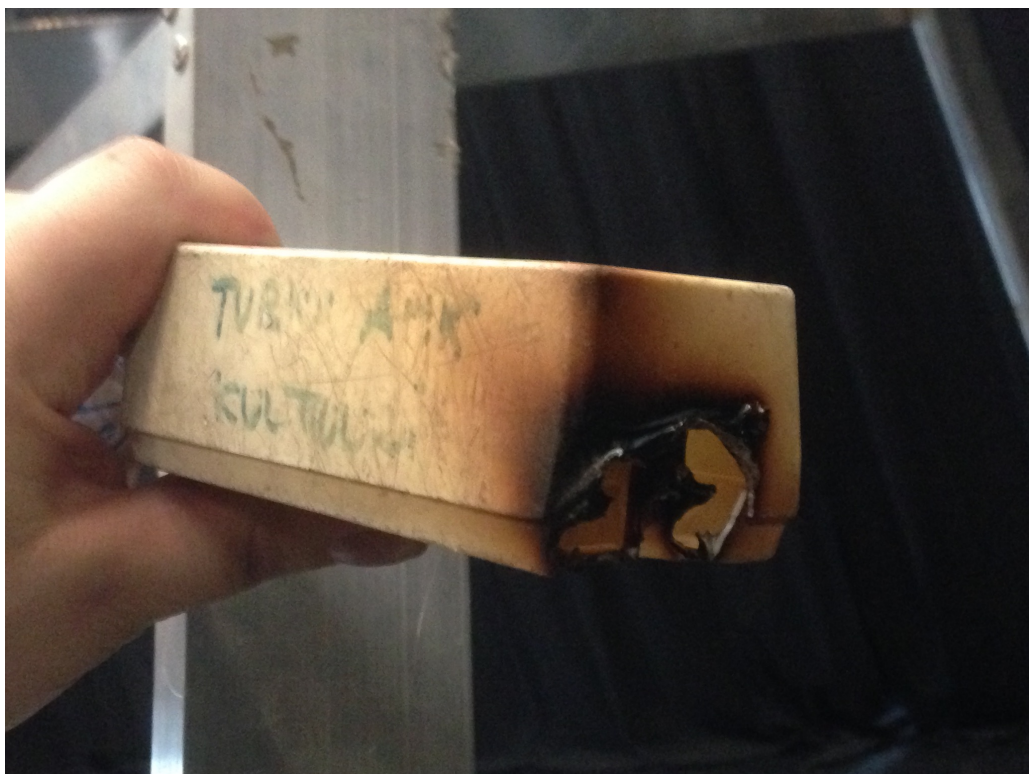
Kuva 10. ETC Source4 575w profiilissa kosketuksissa ollut jatkojohdon pistorasiasia.
