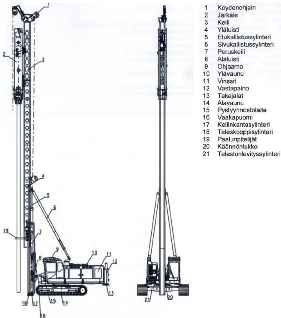
Kuva 2. Paalutuskoneen rakenne. Kuvassa on Suomessa yleisin käytetty paalutuskone Junttan PM20LC [5].
