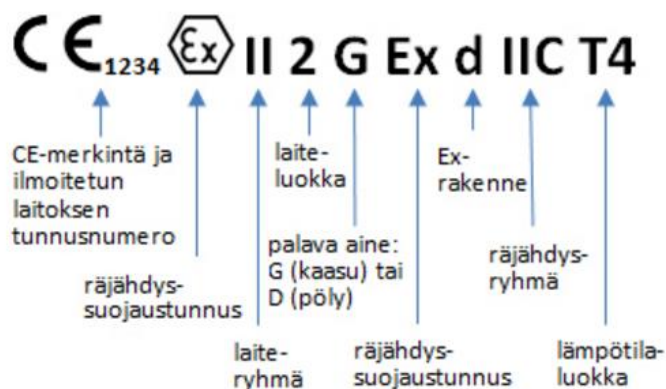
Kuva 6. Merkinnät ATEX laitteessa
