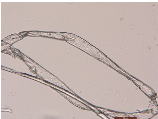
Kuva 7. Kuitunäyte suurennos 200x (puuvilla)
