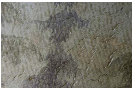
Kuva 17. Maalipinnan rypistyminen, suurennos 4,725x
