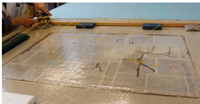
Kuva 40. Vuorausliiman aktivointi alipainepöydällä
