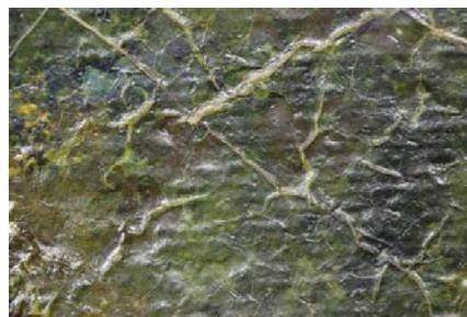
Kuva 19. Kuivumiskrakelyyri, suurennos 7,875x
