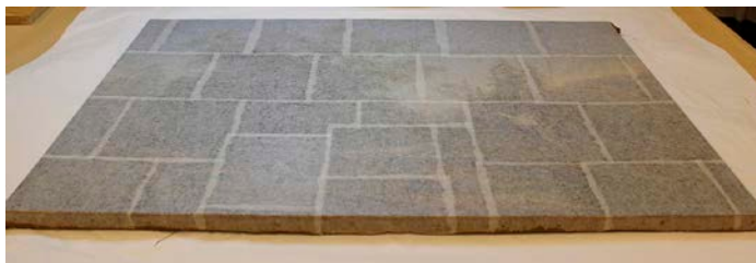
Kuva 27. Pintasuojaus on laitettu
