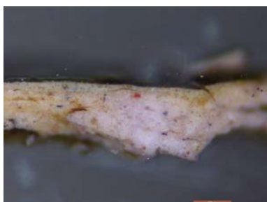
Kuva 10. Poikkileikkausnäyte pohjustuksesta suurennos 100x
