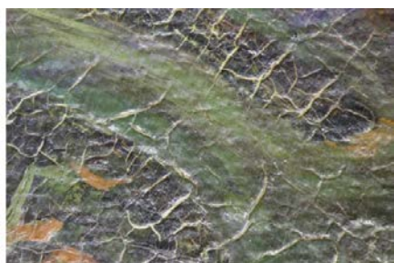
Kuva 18. Kuivumiskrakelyyri, suurennos 4,275x
