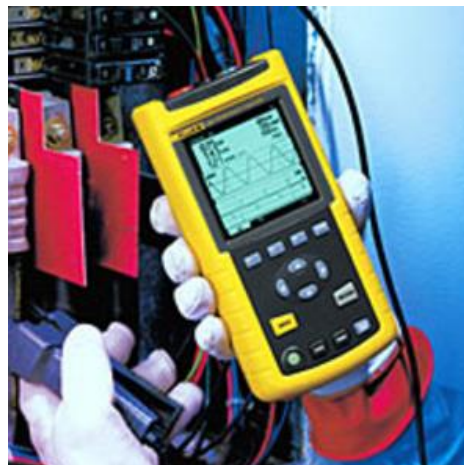
KUVA 19. Fluke 43B sähkönlaadun analysaattori (Fluke 2016)
