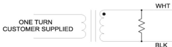
KUVA 9. Virta-jännitemuuntajan toimintaperiaate (Magnetlab 2016)
