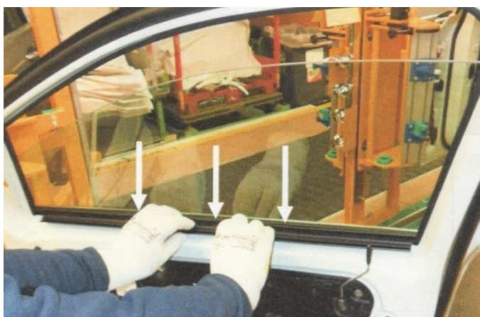
Kuvio 33. Alatiivisteeseen asennus ennen oviverhoilun asennusta (Valmet Automotive Oy).
