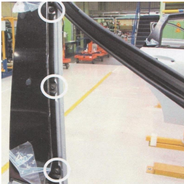
Kuvio 18. Etuoven B-pylvään peitelevyn kiinnitysruuvien sijainnit (Valmet Automotive Oy).
