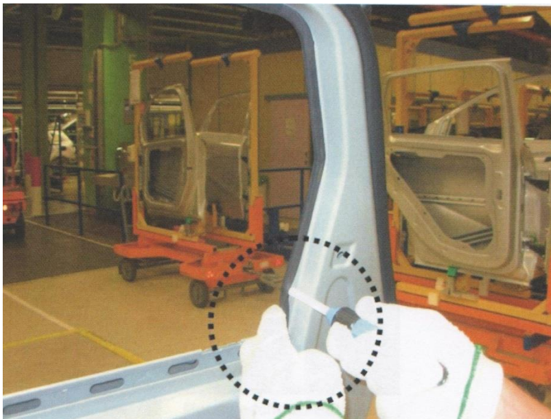
Kuvio 20. Kehätiivisteiden sisäreunan viimeistelytyökalu (Valmet Automotive Oy).
