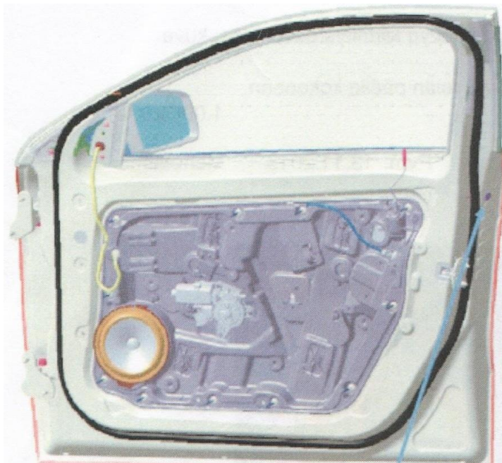
Kuvio 12. Oviverhoilua lukuunottamatta kokoonpantu etuovi (Valmet Automotive Oy).
