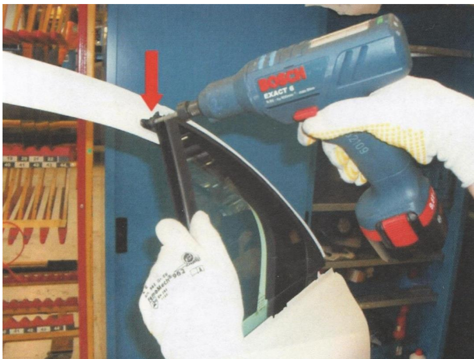
Kuvio 15. Kolmiolasin yläruuvien sijainti (Valmet Automotive Oy).
