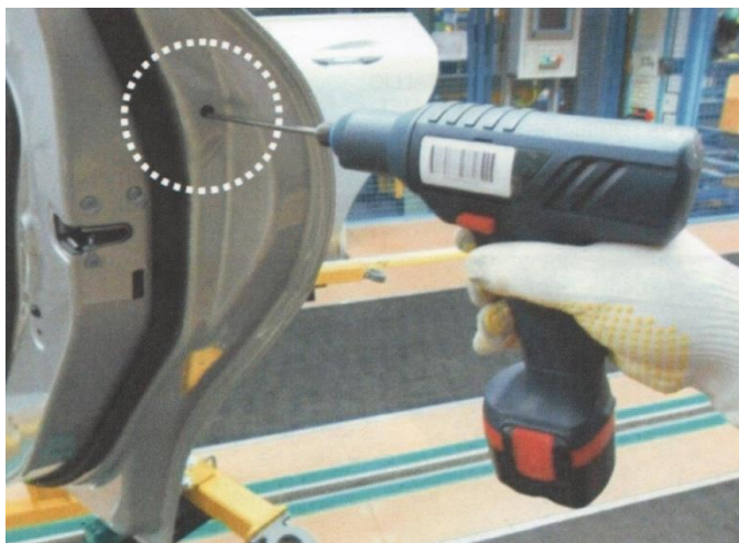
Kuvio 27. Aukaisukahvan peitelevyn ja lukkosylinterin kiinnitys (Valmet Automotive Oy).
