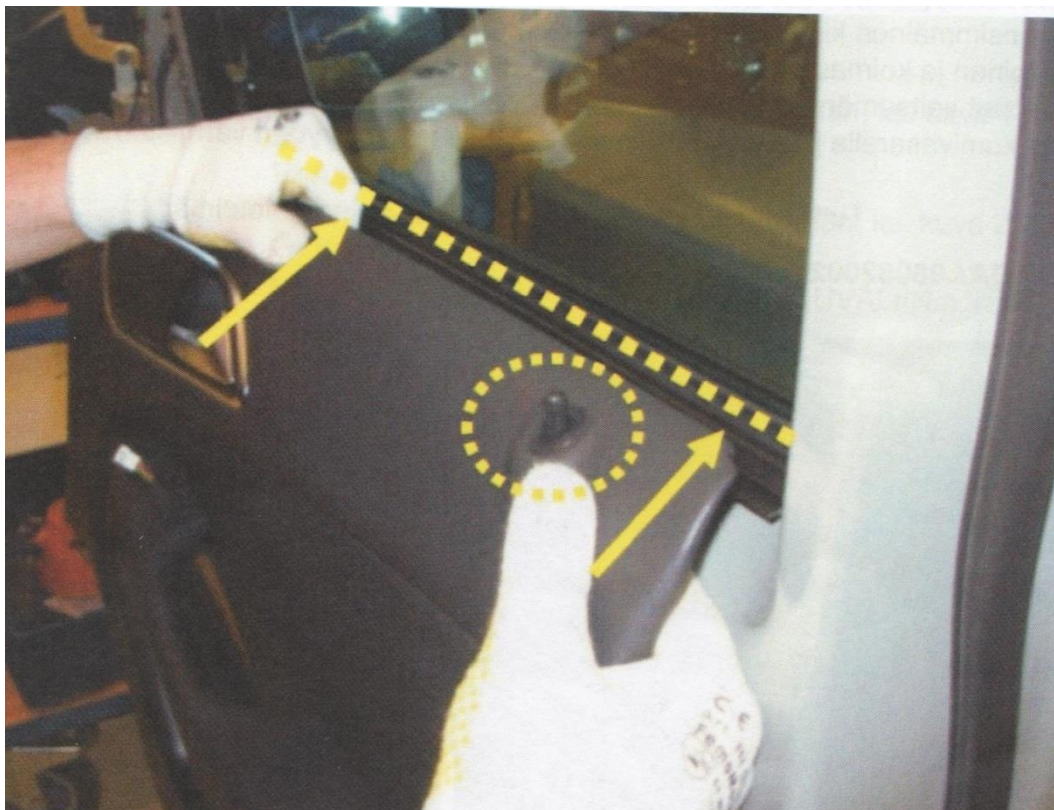
Kuvio 34. Ovi- ja verhoilun yläreunan paikoitus alatiivisteeseen (Valmet Automotive).
