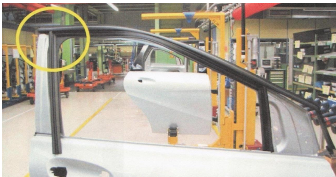
Kuvio 17. Etuoven kehätiivisteiden asennuksen aloituskohta (Valmet Automotive Oy).
