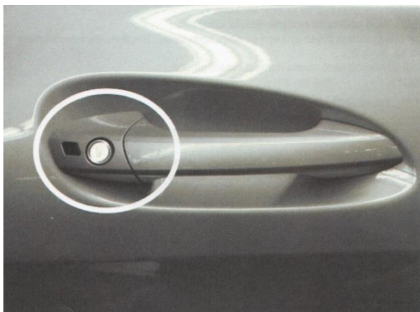
Kuvio 26. Paikoilleen asennettu aukaisukahva ja aukaisukahvan peitelevy (Valmet Automotive Oy).
