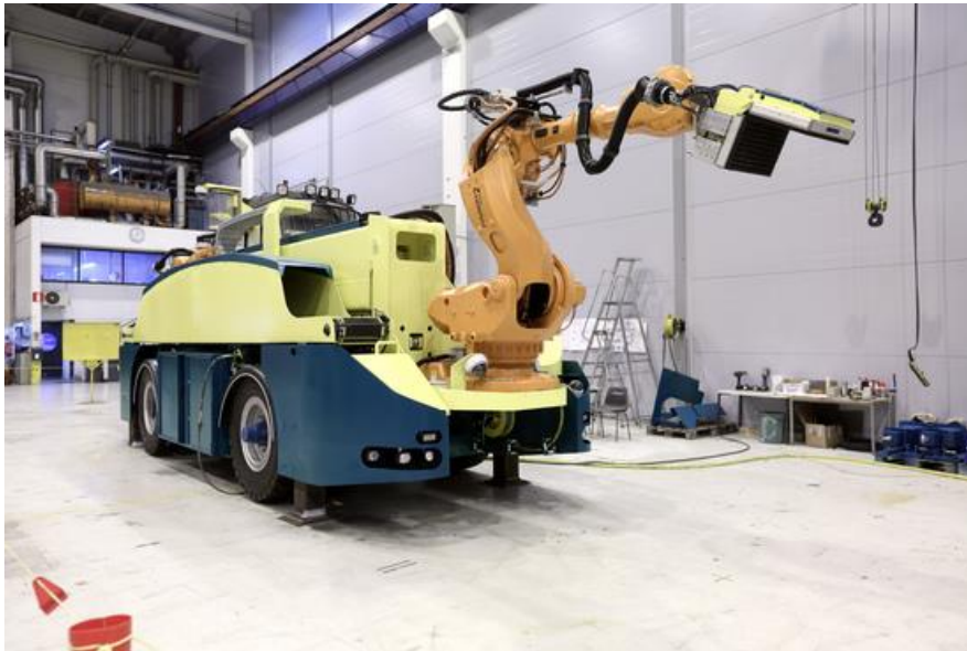
Kuva 12. Tunnelin täyttömateriaalin asennuslaitteen prototyyppi (TMA). (Posivan internetsivut 2015).
