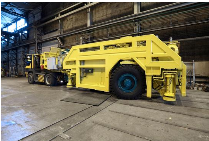
Kuva 10. Kapselin asennuslaitteen KSAA:n prototyyppi ja terminaalitraktori. (Posivan internetsivut 2015).
