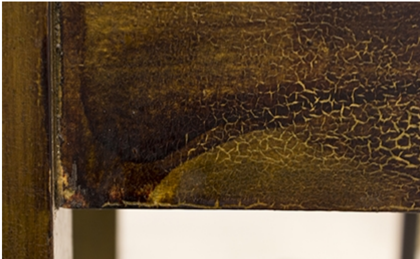
Kuva 15. Raaputtamalla, Ligroinilla ja etanolilla tehdyt koealueet.
