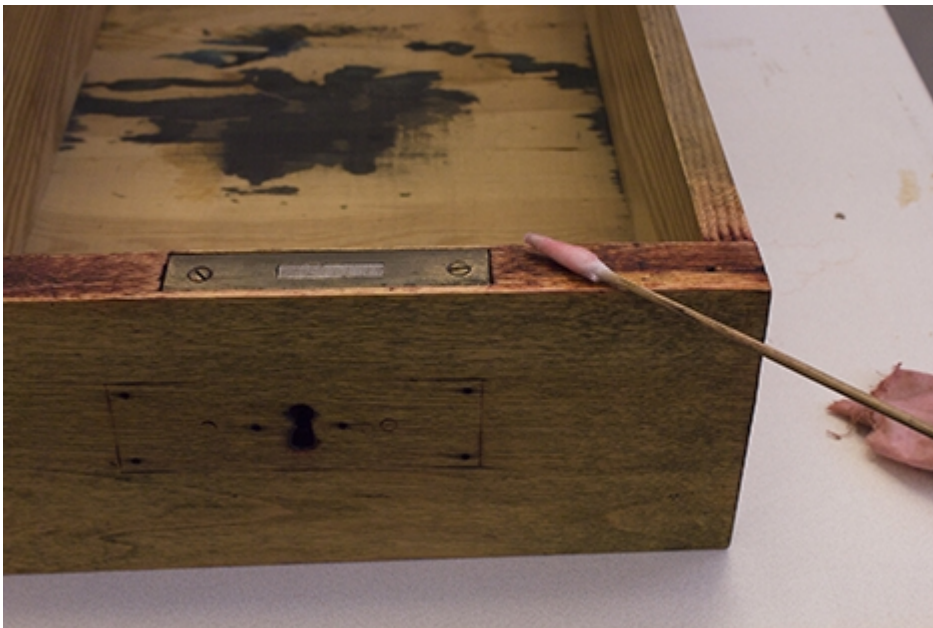
Kuva 27. Laatikon etureuna on jo puhdas, mutta yläreunasta irtoaa vielä väriä.
