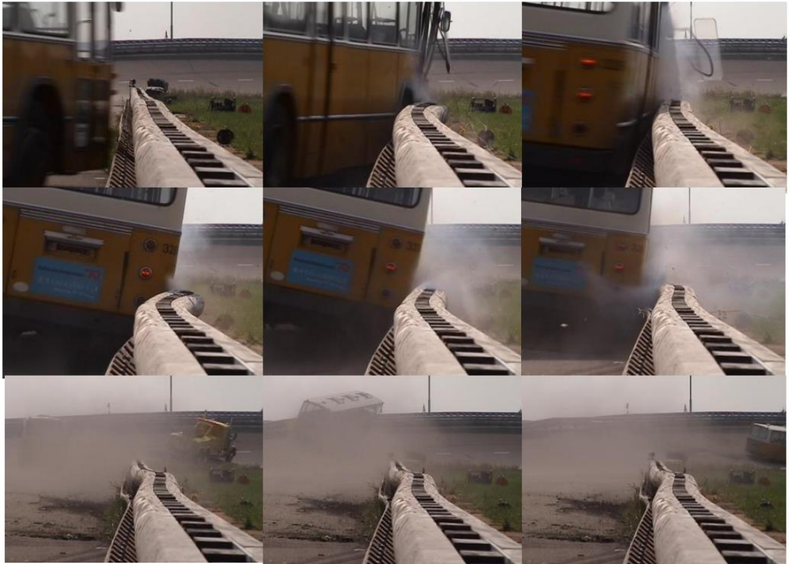
KUVA 18. Puisen tiekaiteen TB 51 –törmäystesti linja-autolla (van de Kuilen, J. W. G).
