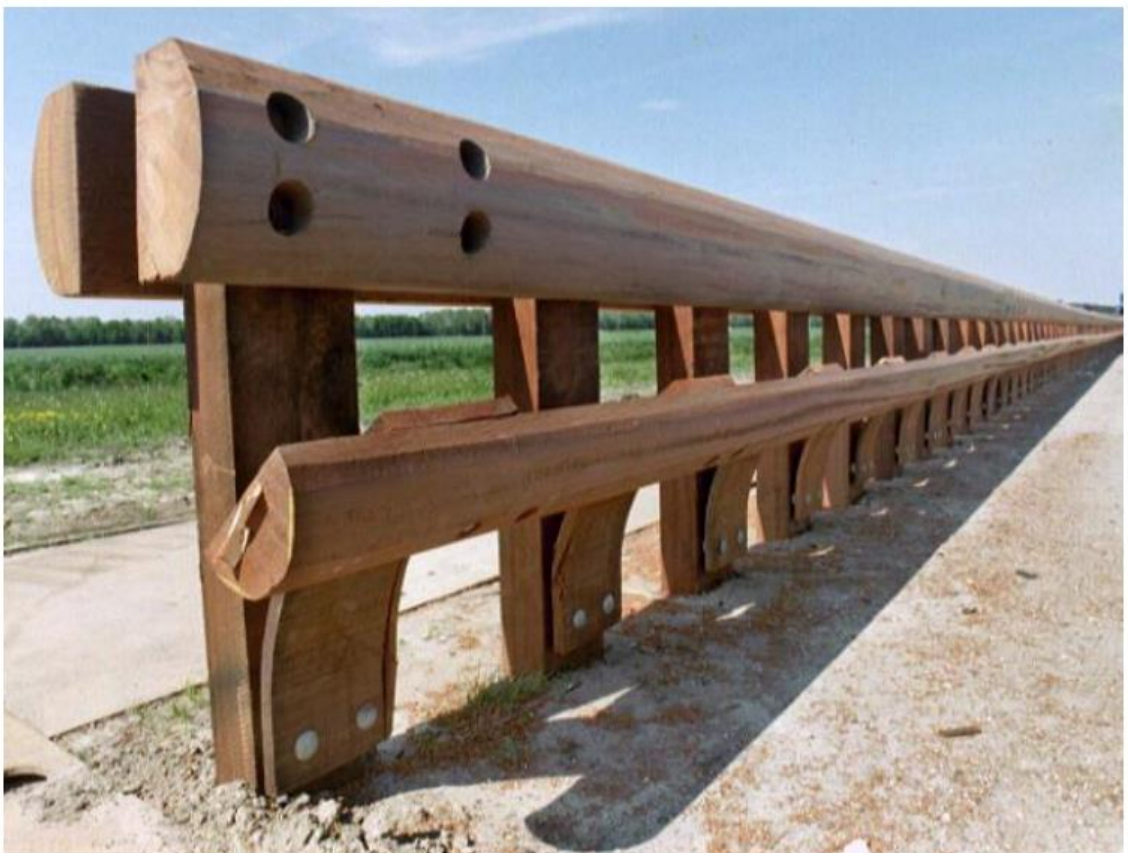
KUVA 11. Puisen tiekaiteen prototyyppi testauspaikalla (van de Kuilen, J. W. G).
