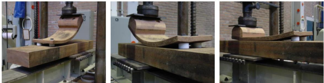
KUVA 12. Höyrytaivutettujen puuluskojen testausta
