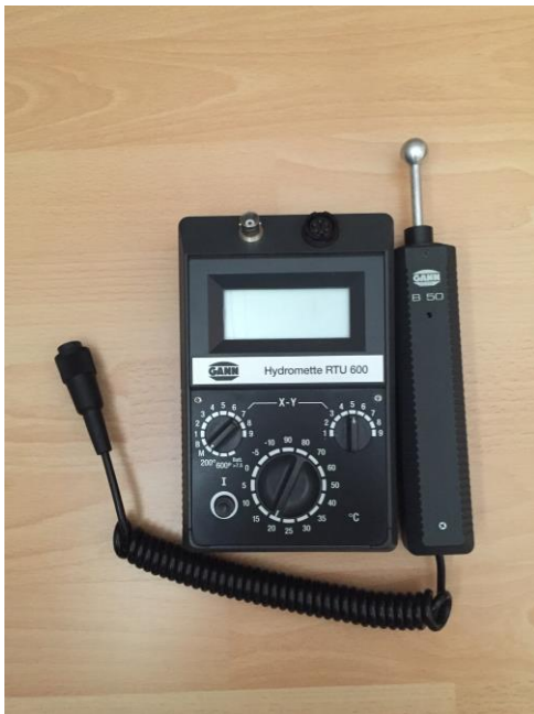
Kuva 3. Gann Hydromette RTU 600 -kosteusmittari ja aktiivielektrodi B50.
