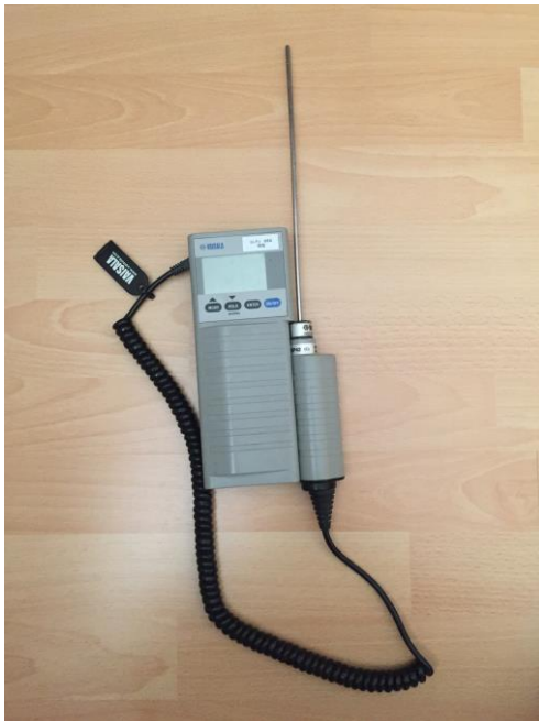
Kuva 4. Vaisala HM41- näyttölaite ja HMP42 -mittapää.
